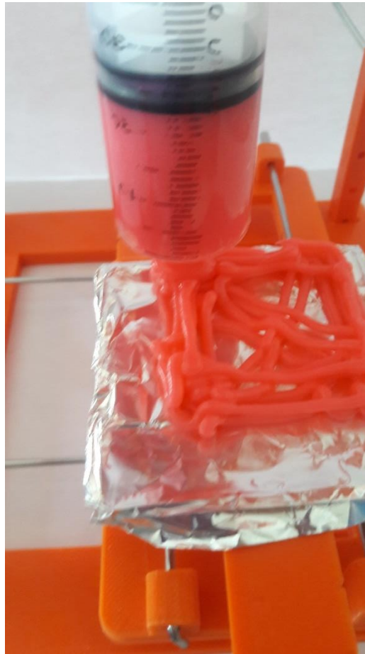
Figura 30 – Extrusora para a deposição de materiais, simulando os eixos X e Y de uma impressora 3D.
