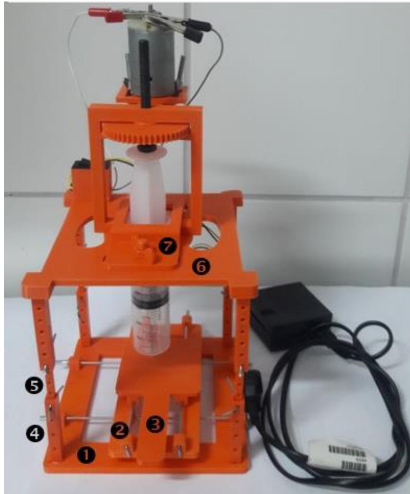
Figura 24 – Base extrusora de deposição de materiais. 1 – Base 1; 2 – Base 2; 3 – Base 3; 4 – Haste Exterior; 5 – Haste Interior; 6 – Base superior; 7 – Suporte trava seringa superior.
