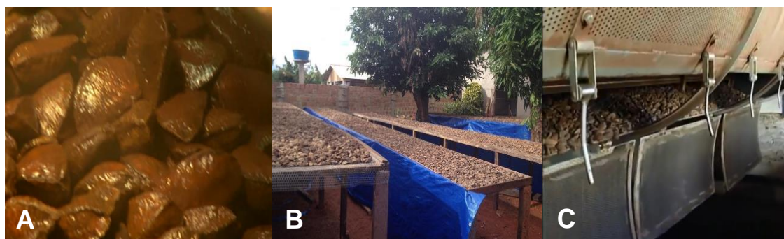
Figura 3.12 Sementes da CDB no início do processo de beneficiamento. A) Autoclavagem[44]. B) Secagem ao sol[38]. C) Secagem em tambores de secagem rotativos[44].
