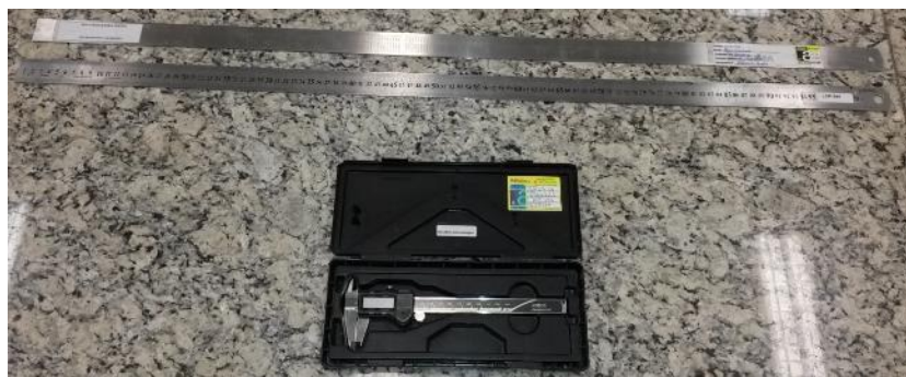
Figura 3.21 Régulas calibradas e paquímetro utilizados nas medições. Fotografado pelo autor[8].
