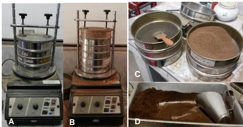
Figura 3.7 Processos de peneiração do materiais lignocelulósicos moídos. A) Peneiração do pó para obtenção de partículas entre 18 e 50 mesh e maiores que 50 mesh no agitador magnético. B) Peneiração do pó para obtenção de partículas entre 60 e 80 mesh no agitador magnético. C) Peneiras com o pó. D) Um dos pós resultantes. Fotografado pelo autor[8].
