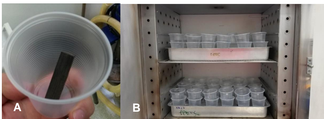
Figura 3.39 Ensaio de absorção de umidade: A) Corpo de prova de ensaio de absorção de água dentro de um copo descartável vazio. B) Amostras sendo ensaiadas, imersas em água destilada, dentro de uma estufa, sob temperatura controlada. Fotografado pelo autor[8].
