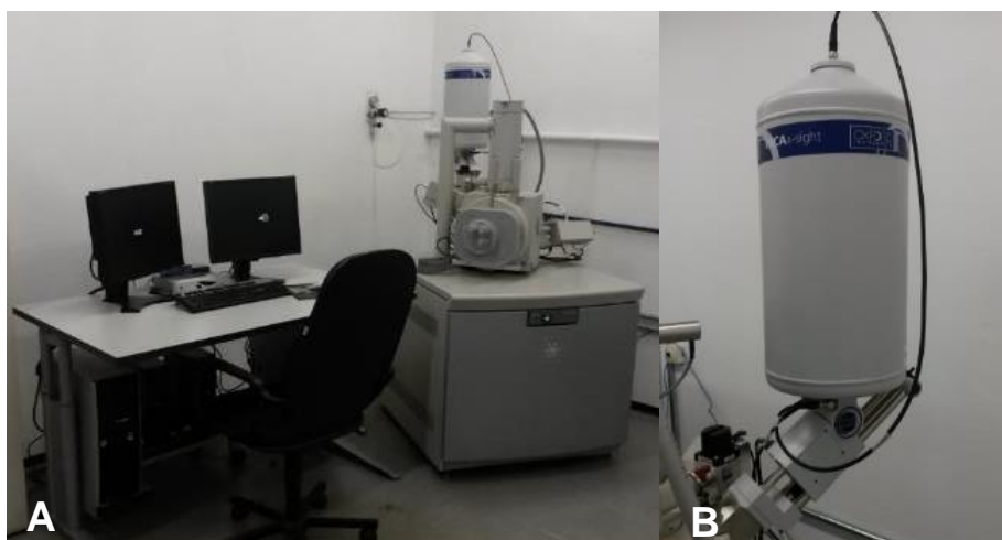
Figura 3.27 Equipamento utilizado na análise elementar das cinzas. A) MEV marca FEI, modelo Quanta, com um EDS marca Oxford, modelo Inca Energy 250, acoplado. B) Detalhe do equipamento de EDS acoplado ao MEV. Fotografado pelo autor[8].
