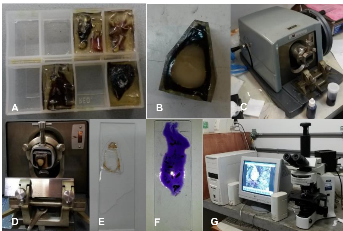
Figura 3.17 Processo para obtenção de imagens por MOL. A) Amostras amolecidas e embutidas em parafina ainda no molde. B) Amostra embutida pronta para ser fatiada. C) Micrótomo utilizado no fatiamento das amostras. D) Amostra sendo fatiada no micrótomo. E) Amostra já fatiada em uma lâmina. F) Amostra sendo quimicamente atacada. G) Microscópio biológico trinocular Olympus BX-51 e sistema de captura. Fotografado pelo autor[8].
