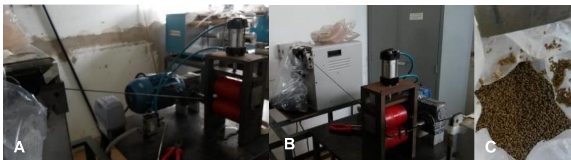
Figura 3.11 A) Sistema de rolos guia de alimentação da cortadora. B) Cortadora de fios sendo alimentada. C) Fio de uma das composições já cortado em grânulos. Fotografado pelo autor[8].
