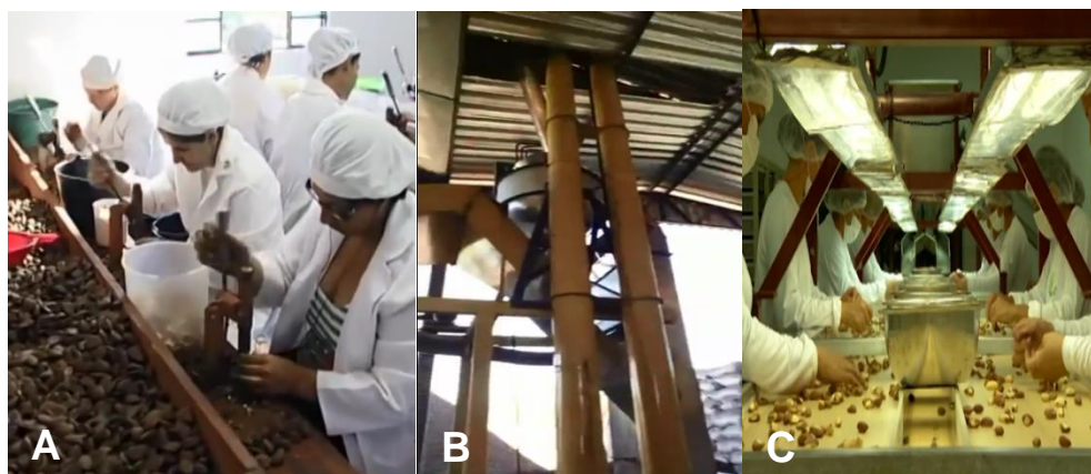
Figura 3.13 Processo de beneficiamento da CDB nas etapas de quebra das cascas e seleção. A) Quebra manual das sementes[44]. B) Processo industrializado com quebradora automática[38]. C) Esteira de seleção manual das amêndoas[44].
