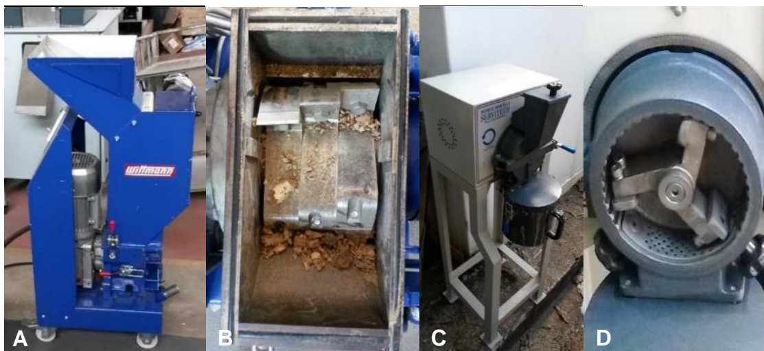
Figura 3.4 A) Moinho de facas Wittmann MAS1 (3CV). B) Rotor do moinho de facas Wittmann. C) Moinho de martelos Servitech CT-03 (2CV). D) Rotor do moinho de martelo Servitech. Fotografado pelo autor[8].
