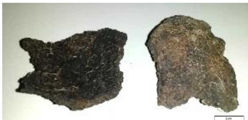
Figura 3.53 EX fraturado mostrando sua superfície interna à esquerda e sua superfície externa à direita. Fotografado pelo autor[8].
