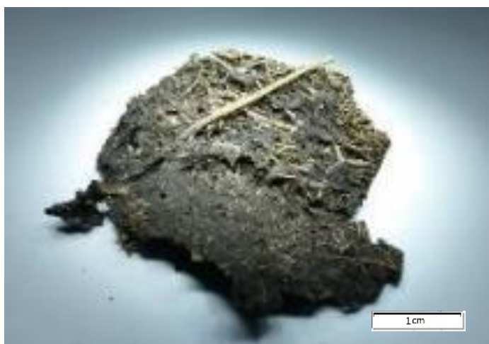
Figura 3.69 Parte fraturada do endocarpo (EC) mostrando, em escuro, regiões de células parenquimáticas e, em bege, regiões de vasculares e fibras. Fotografado pelo autor[8].
