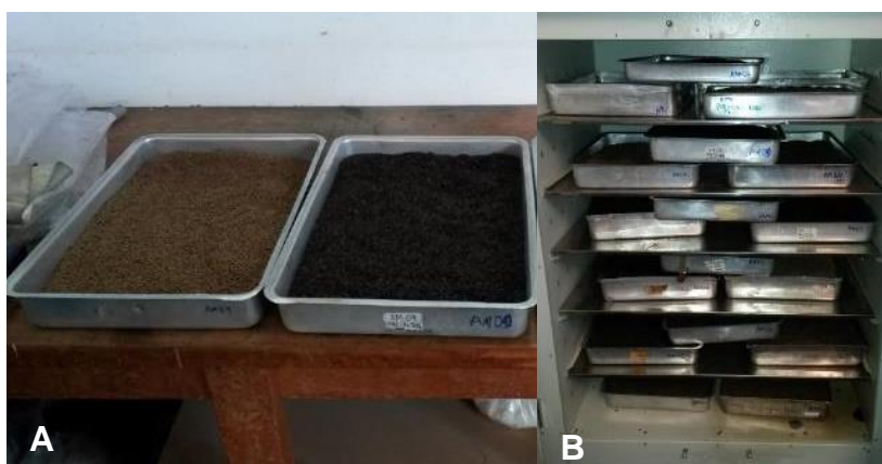
Figura 3.12 A) Grânulos dos biocompósitos nas bandejas. B) Bandejas com os grânulos na estufa durante a secagem. Fotografado pelo autor[8].
