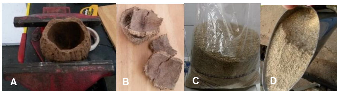
Figura 3.5 Etapas de moagem dos MC . A) Quebra do MC na morsa. B) Pedacos quebrados do MC para moagem no moinho de facas. C) Partículas menores que 4 mesh após moagem no moinho de facas. D) Partículas menores que 18 mesh após moagem no moinho de martelos. Fotografado pelo autor[8].
