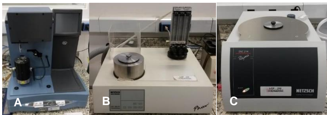
Figura 3.34 Equipamentos utilizados na análise térmica: A) Equipamento para ensaio de TGA, marca TA Instruments, modelo Q500. B) Equipamento para ensaio de OOT, marca Netzsch, modelo DSC 200 PC Phox. C) Equipamento para ensaio de DSC marca Netzsch, modelo DSC 214 Polyma. Fotografado pelo autor[8].
