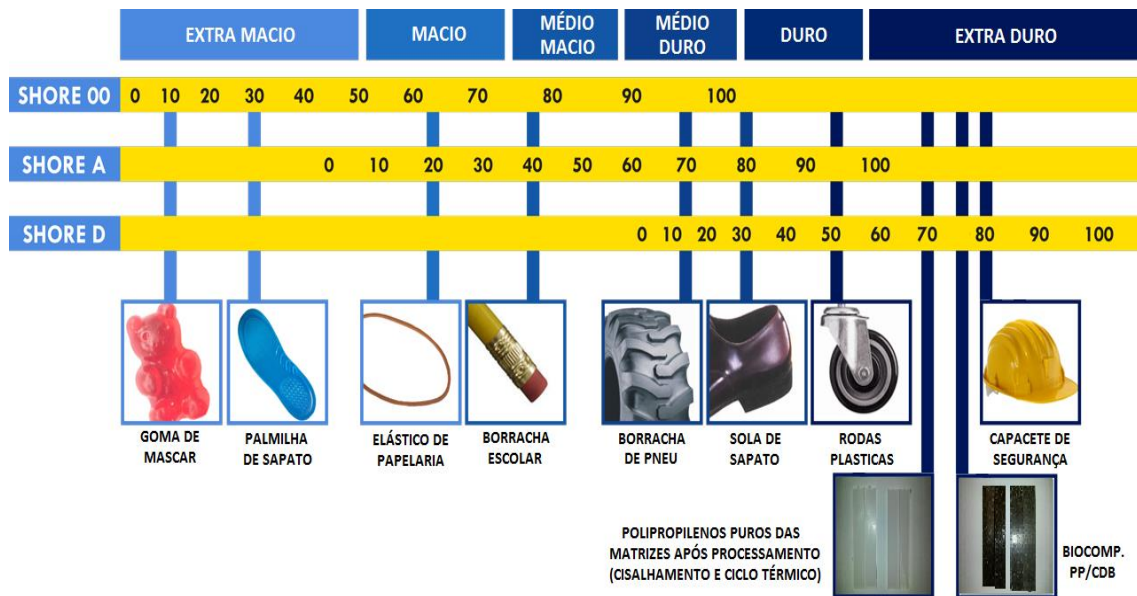
Figura 3.186 Comparação de resultados de dureza dos PP utilizados nas matrizes e dos biocompósitos PP/CDB, em termos de aplicação, com outros polímeros em geral. Adaptado de Albright Technologies[291]
