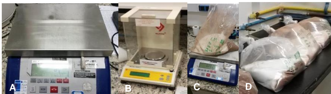
Figura 3.9 A) Balança comum Metter Viper BC. B) Balança de precisão Quimis BG 400. C) Montagem de uma composição. D) Sacos plásticos com as composições para agitação mecânica e homogeneização. Fotografado pelo autor[8].
