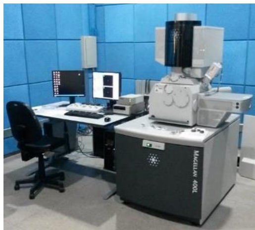
Figura 3.19 A) MEV-FEG Magellan 400L utilizado na captação das imagens com aumento até 1.000.000X. Fotografado pelo autor[8].
