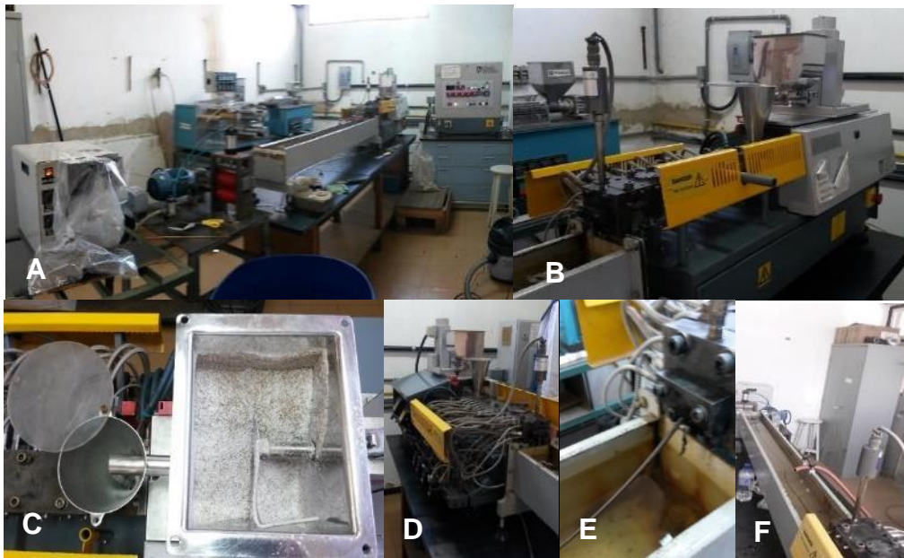
Figura 3.10 Processo de extrusão dos grânulos. A) Conjunto do processo. B) Extrusora B&P MP19. C) Misturador e funil de alimentação. D) Região do barril de extrusão. E) Matriz de extrusão. F) Calha de resfriamento. Fotografado pelo autor[8].
