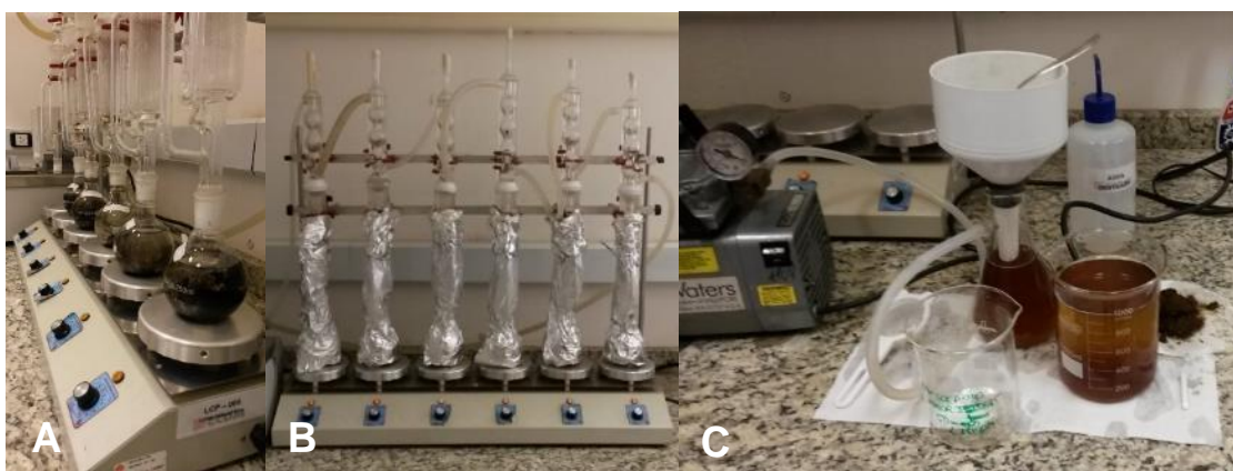
Figura 3.28 Equipamentos e processo de separação dos extraíveis dos polímeros estruturais. A) Conjunto montado para extração via Soxhlet. B) Extração via Soxhlet. C) Remoção dos solventes com funil de Büchner acoplado a um Kitassato e sucção. Fotografado pelo autor[8].
