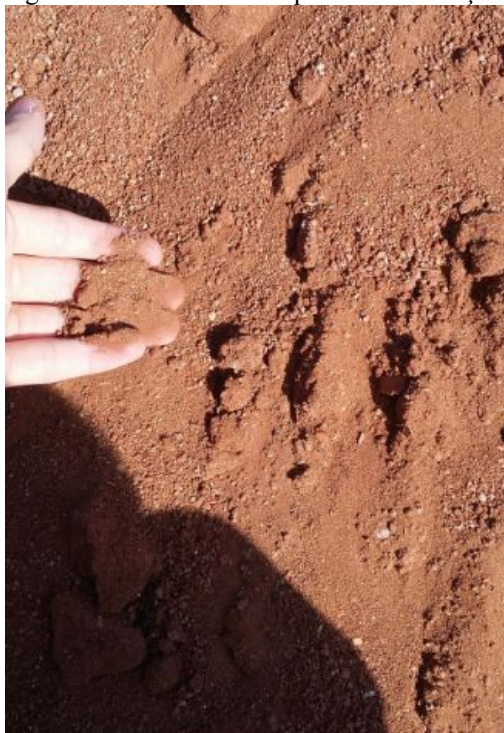
Figura 23 - Entulho moído para base de calçada
