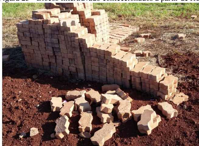
Figura 25 - Blocos Intertravado confeccionados a partir de RCC
