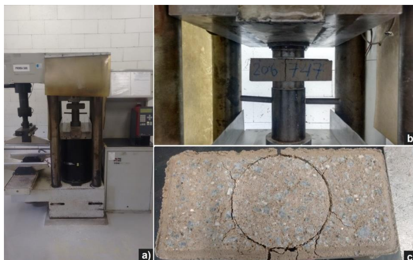
Figura 49 - Ensaio de resistência à compressão: a) prensa; b) posição da peça durante o ensaio; c) peça rompida.
