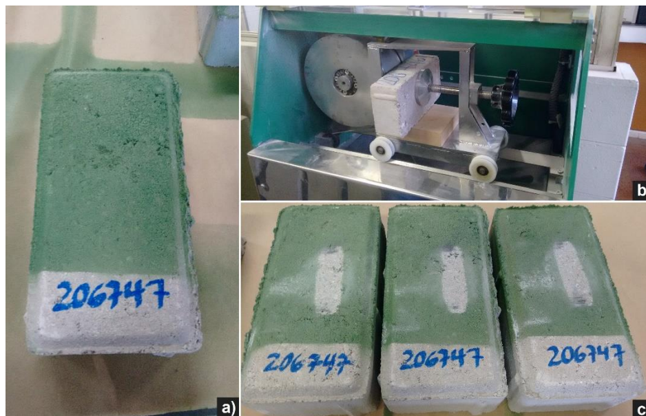
Figura 48 - Ensaio de resistência à abrasão: a) superfície da PCP pronta para o ensaio; b) posicionamento da PCP; c) peças após o ensaio.
