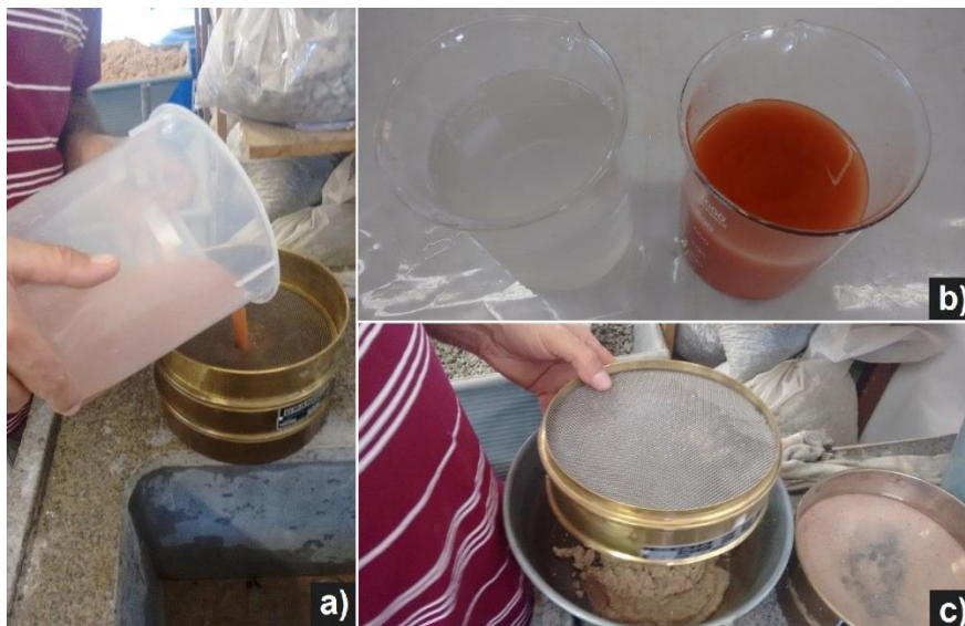
Figura 40 - Determinação do teor de material pulverulento: a) amostra vertida sobre as peneiras; b) águas da primeira e última lavagem; c) retorno da amostra lavada em recipiente metálico.
