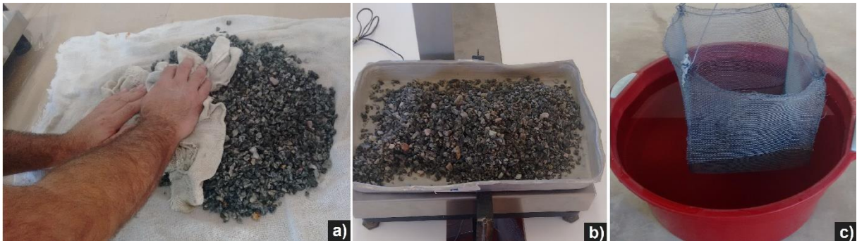
Figura 42 - Determinação da massa específica para agregados graúdos: a) extração da umidade superficial; b) pesagem no estado SSS; c) amostra submersa para pesagem.
