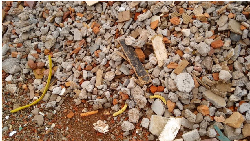
Figura 29 - Exemplo de RCC
