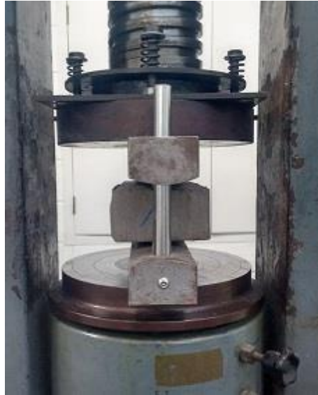
Figura 28 - Ensaio de tração por compressão diametral em PCP
