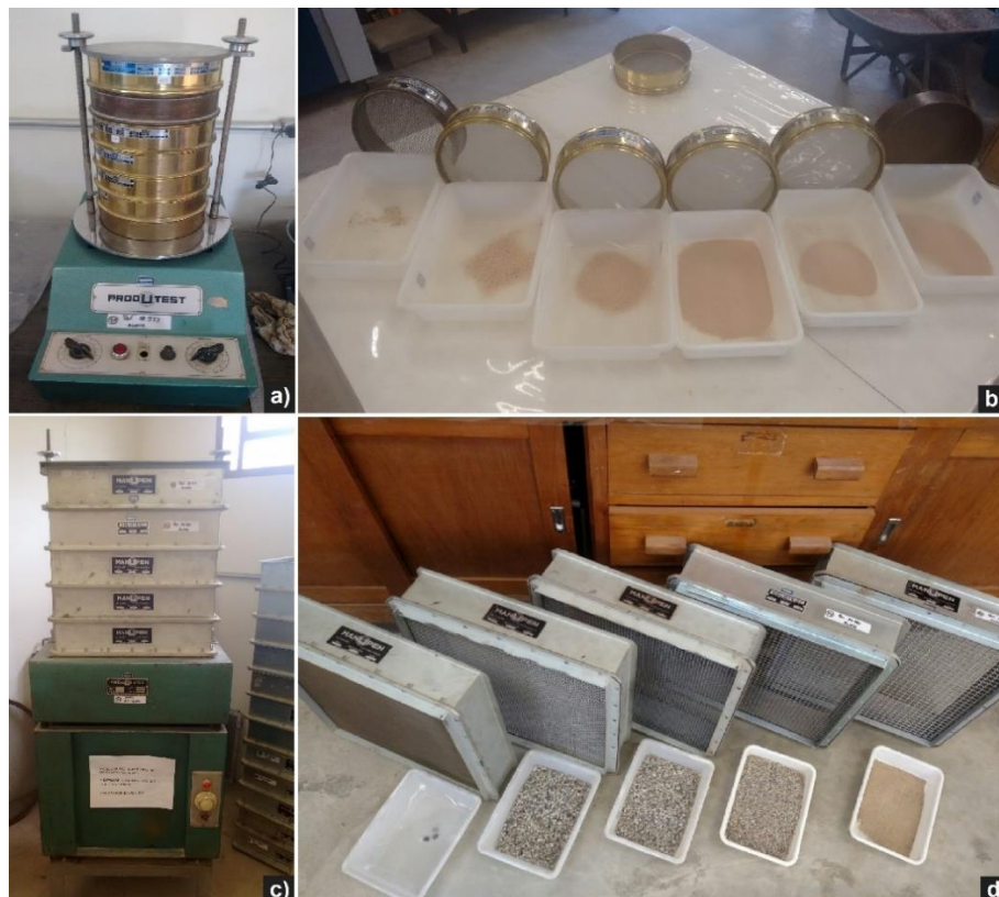
Figura 38 - Ensaio de análise granulométrica: a) misturador mecânico para agregados miúdos; b) frações retidas nas peneiras; c) misturador para agregado graúdo; d) frações retidas nas peneiras.
