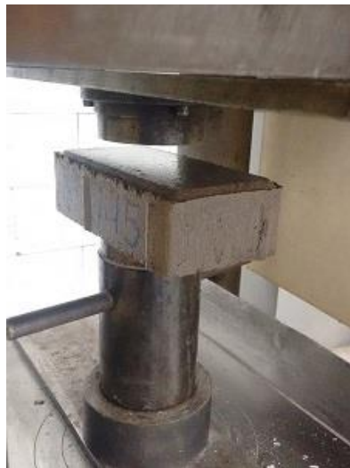
Figura 25 - Ensaio de compressão em PCP
