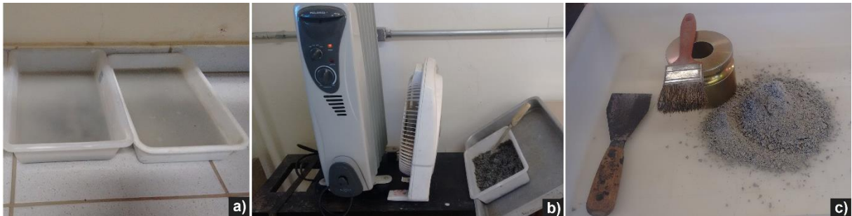
Figura 43 - Ensaio de absorção de água: a) amostras imersas; b) secagem; c) agregado na condição SSS.
