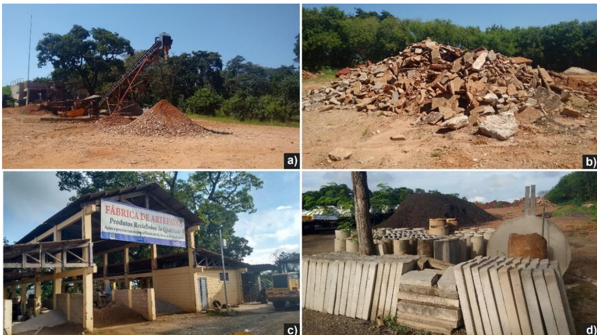
Figura 33 - Usina de Reciclagem de RCC de Rio Preto: a) britador; b) resíduo cinza; c) fábrica de artefatos; d) artefatos produzidos com resíduos.
