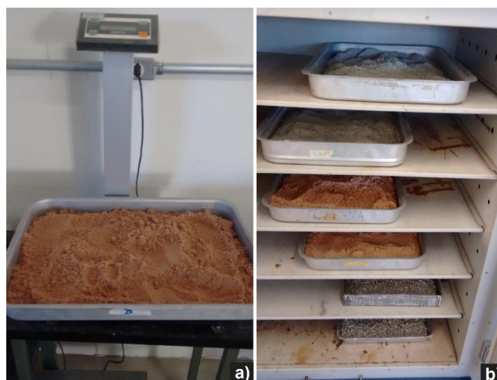
Figura 37 - Obtenção do teor de umidade total: a) pesagem inicial; b) secagem em estufa.
