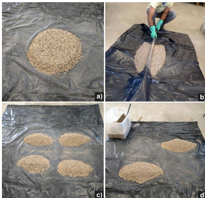
Figura 36 - Quarteamento do agregado graúdo: a) cone achatado; b) divisão; c) material dividido; d) final do quarteamento.
