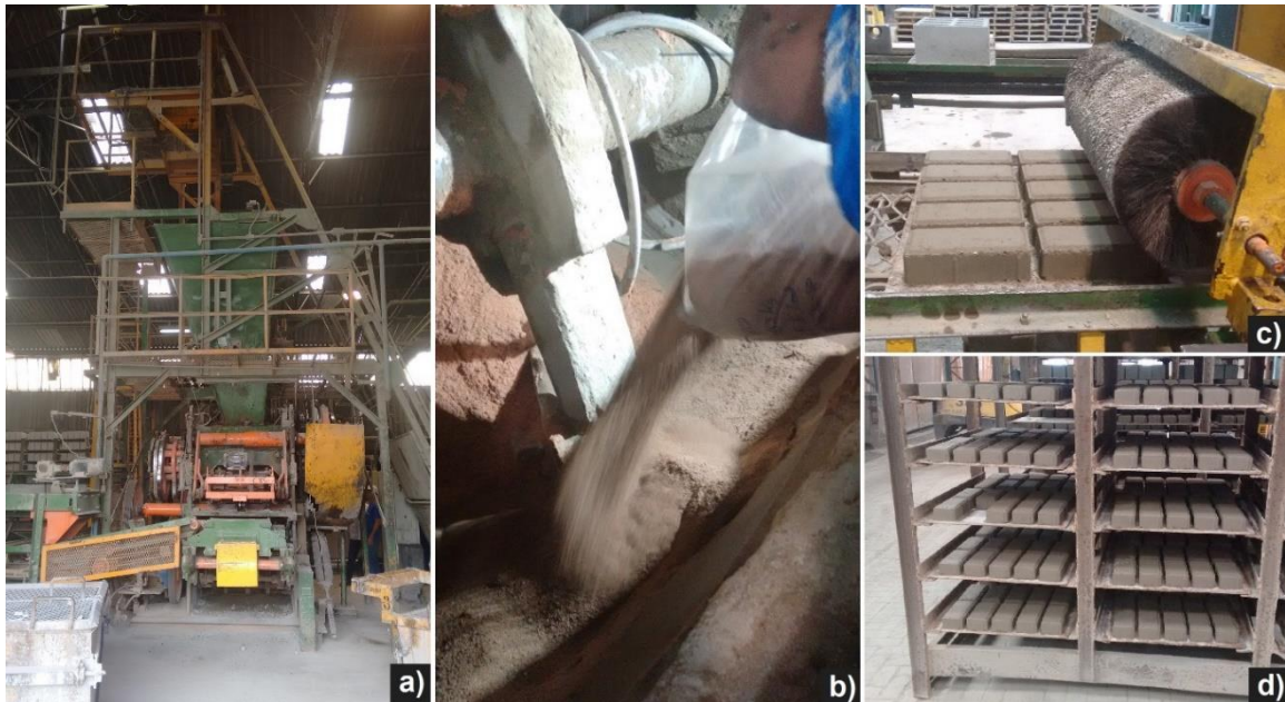
Figura 44 - Fabricação das PCP: a) vibroprensa; b) inserção da areia reciclada; c) regularização após desforma; d) peças prontas.
