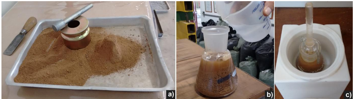
Figura 41 - Determinação da massa específica para agregados miúdos: a) agregado na condição SSS; b) adição de água; c) banho térmico.
