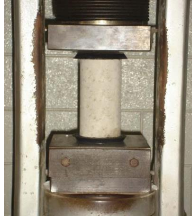
Figura 24 - Ensaio de resistência à compressão em corpo de prova cilíndrico
