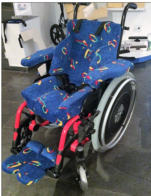
Figura 12: produto final proveniente do sistema digitalizado de assento e encosto de cadeira de rodas.
