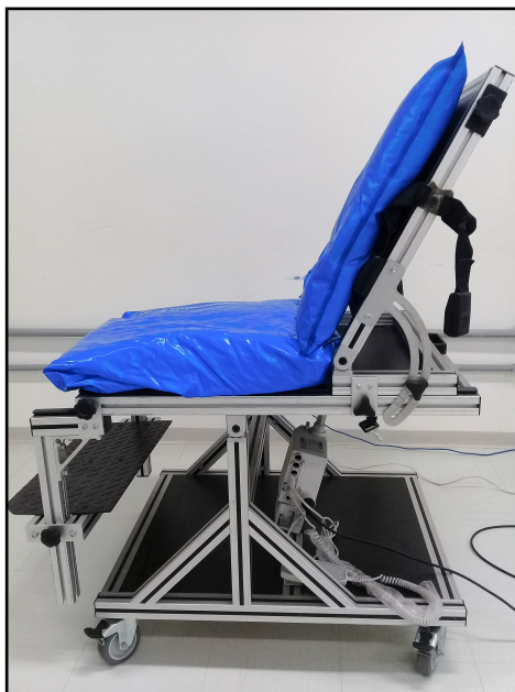
Figura 8: sistema digitalizado de assento e encosto de cadeira de rodas com aplicação de 20° de recline.
