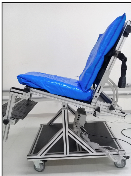
Figura 6: sistema digitalizado de assento e encosto de cadeira de rodas.
