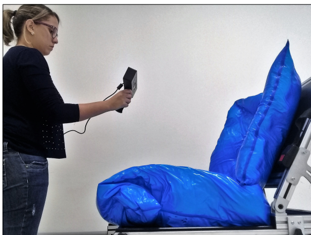
Figura 10: etapa de digitalização da superfície modelada.
