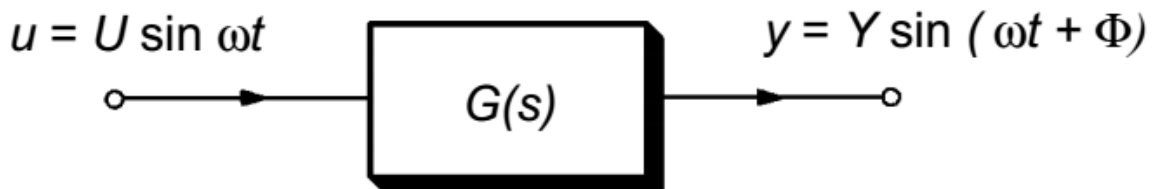
FIGURA B.5 – Representação de uma perturbação senoidal u sendo aplicada em um sistema com função de transferência G(s) e obtenção de uma resposta y .
