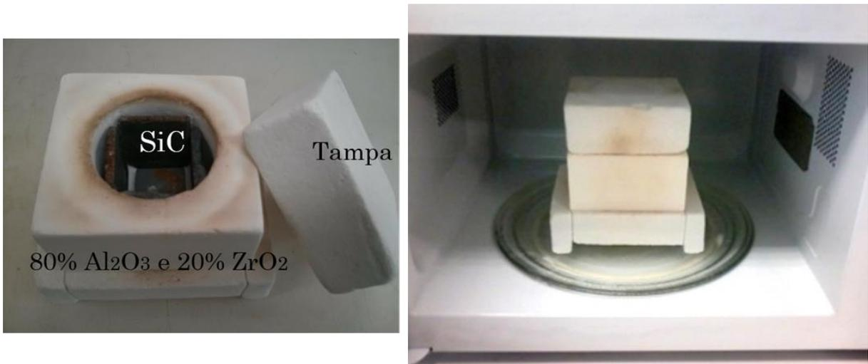
FIGURA 3.2 - Fotos do reator utilizado no tratamento térmico (Fonte: A autora).
