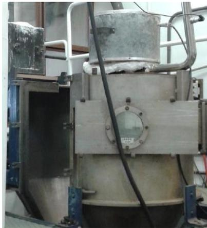
Figura 4.2 - Equipamento para conformação por spray utilizado para processamento da liga 6061 modificada.
