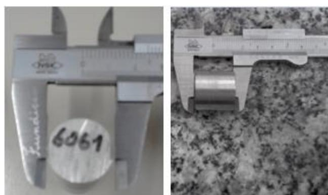
Figura 4.8 – Barras utilizadas para extrusão.
