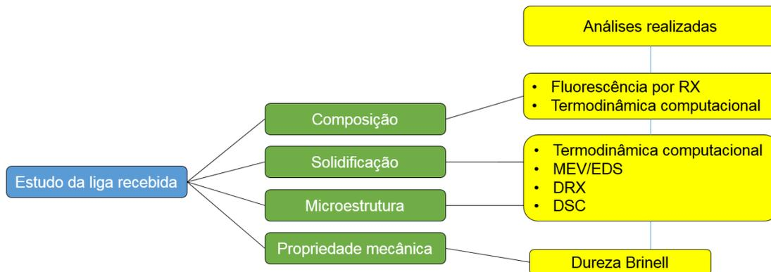
Figura 4.3 – Fluxograma indicando os experimentos realizados na caracterização do material recebido.
