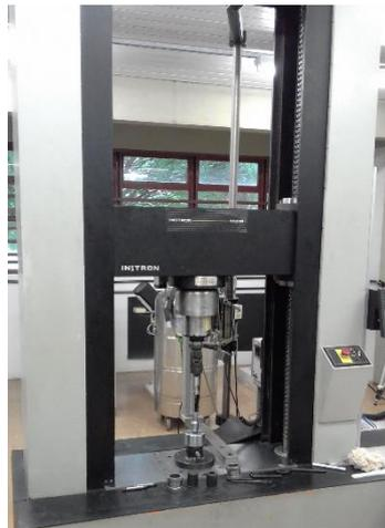
Figura 4.14 – Máquina universal de ensaios mecânicos utilizada para ensaios de tração.
