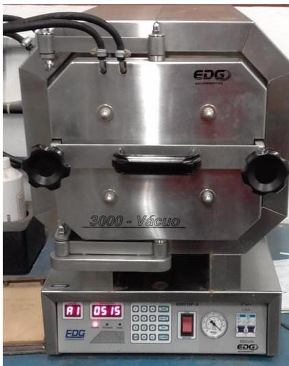
Figura 4.12 - Forno utilizado para realização dos tratamentos térmicos.
