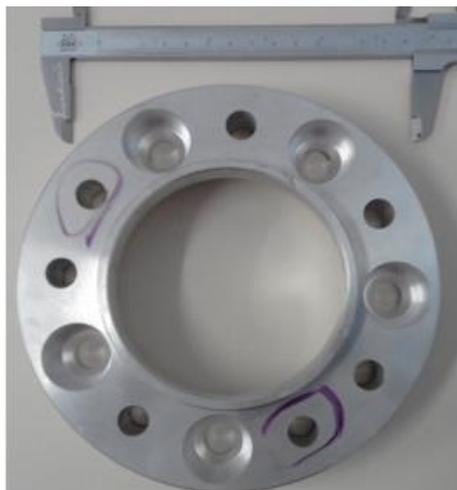
Figura 4.1 – Espaçador de roda automotiva fabricado com a liga 6061.
