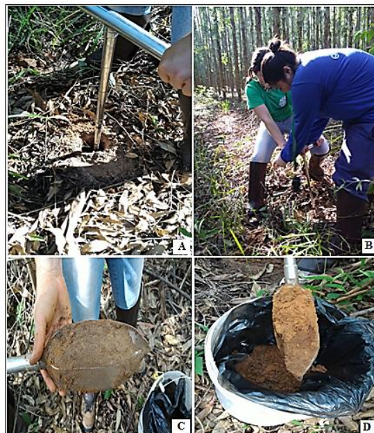
Figura 3- Amostragem de solo em campo, sendo A- trado holandês, B- coleta de solos, C- exemplo de amostra simples, D- acondicionamento da amostra composta.
