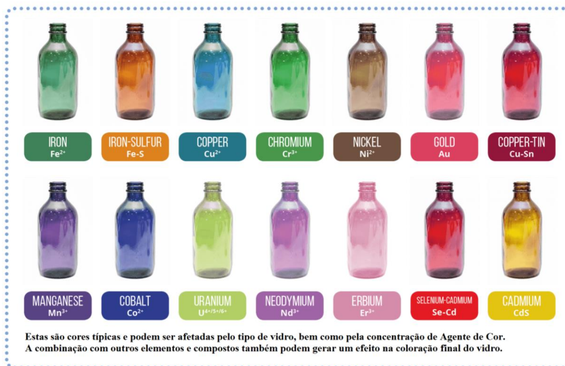
FIGURA 1.10 – Influência de diferentes agentes de cor nos vidros produzidos comercialmente.
