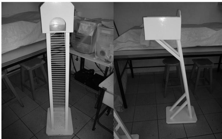
**Figura 4.** Escada de madeira utilizada no protocolo de treinamento resistido. Contém 110 cm de altura com degraus de ferro e inclinação de 80 graus. Vista frontal (painel à esquerda) e vista lateral (painel à direita).
