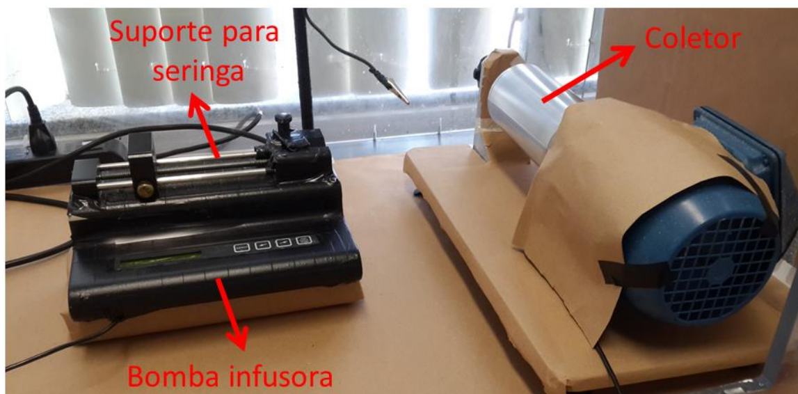
FIGURA 4.1 - Fotografia digital do aparato instrumental de eletrofição utilizado no presente trabalho.
