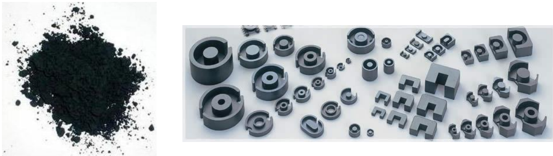
Figura 2.13 Foto de ferrita de cobalto em pó e sinterizadas e moldadas para aplicação em transformadores e blindagem magnética..
