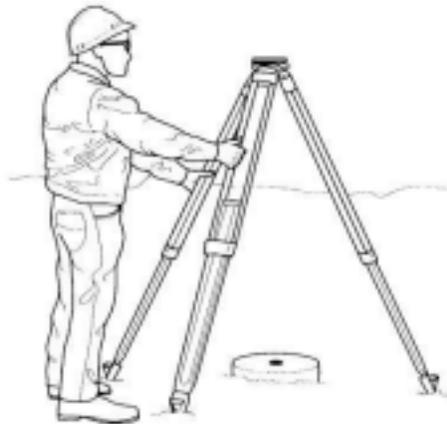
Figura 39 : Tripé (suporte do teodolito)
