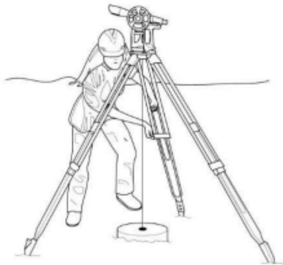
Figura 41: Tripé com o teodolito ajustado ao piquete
