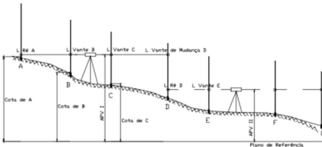
Figura 64: Nivelamento Geométrico (leitura das cotas alternando a mira e o teodolito)
