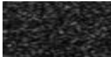
Figura 2.2: Efeito granular do “speckle” após o imageamento. O ruído dificulta a análise e interpretação das imagens.
