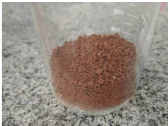
FIGURA 5.3 – Óxido de ferro (III) sintetizado por um dos grupos de estudantes.
