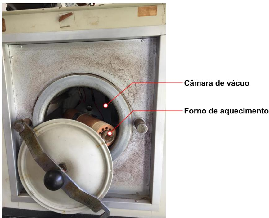
FIGURA 3.4 - Sistema usado na secagem dos eletrodos a ~120 °C por ~12 horas.
