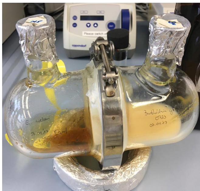
Figura 3-2 – Sistema (“chamber”) utilizado para cocultivo em meio líquido.
