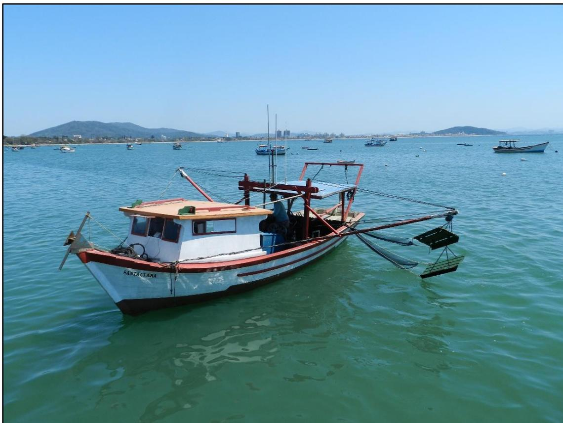
Figura 2 – Embarcação (“Baleeira”) com portas de arrasto duplo (“Double rig”) utilizada nas amostragens experimentais. Fonte: Fotografias do autor
