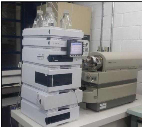
FIGURA 4. 10 -Equipamento de cromatografia líquida de alta eficiência Agilent 1200 acoplado ao espectrômetro de massa tripla quadrupolo com detector de UV.
