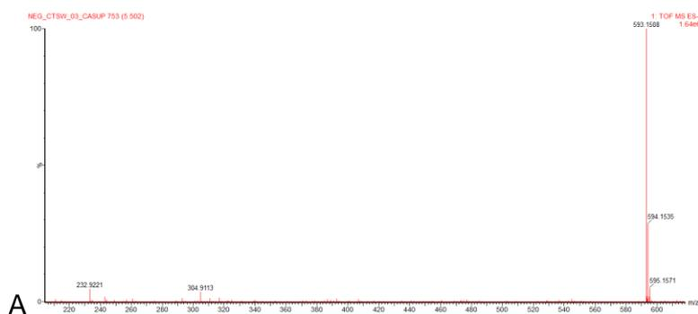
FIGURA 5. 111 - Espectro dos íons moleculares no modo negativo de ionização: a) vicenina-2, com  $m/z$  593,1509; b) didymina, com  $m/z$  593,1509; c) 6,8-di-c-glu-diosmetina, com  $m/z$  623,1615; d) NI, com  $m/z$  579,1769; e) diosmina, com  $m/z$  607,1652; f) hesperidina, com  $m/z$  609,1899 e g) 7-demetilisotamarina, com  $m/z$  245,0824.
