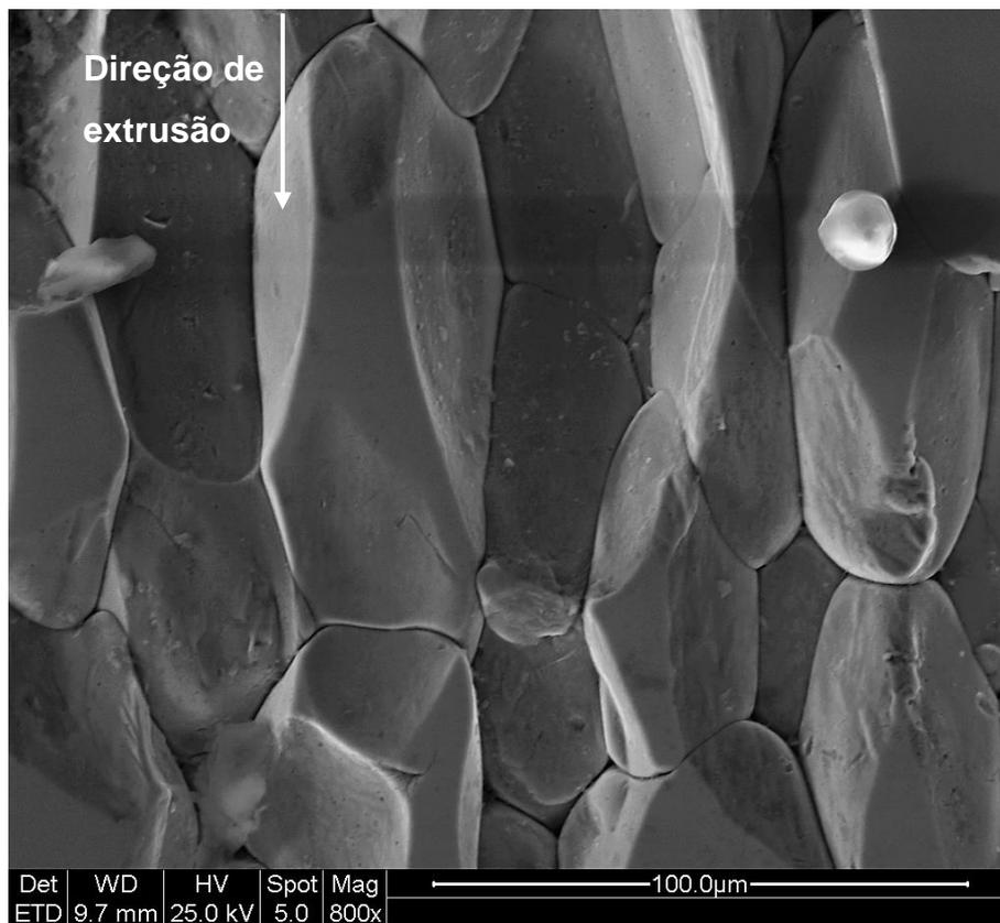
Figura 5.26: Superfície de fratura da amostra Ext 4 ( $V_e = 30$  mm/min, modelo de cápsula = 2).
