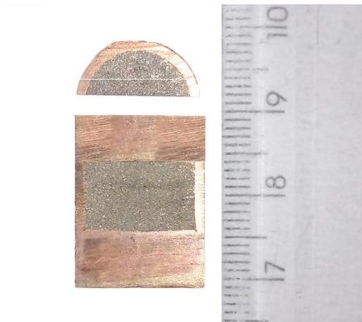
Figura 5.17: Seções longitudinal e transversal da amostra Comp 2 ( $P = 700$  MPa) após processo de prensagem a quente.
