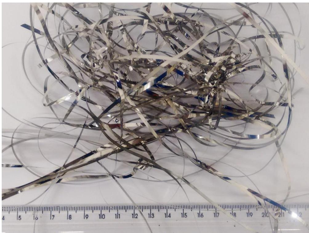
Figura 5.2: Fita produzida a partir do lingote AP pela técnica *melt-spinning*.
