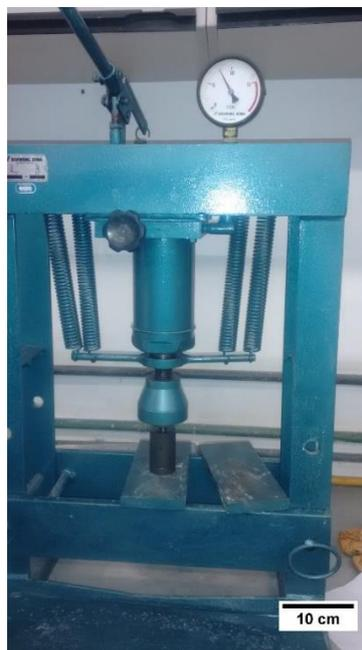
Figura 4.3: Prensa hidráulica Schwing Siwa presente no Laboratório de Cerâmicas do DEMa/UFSCar.
