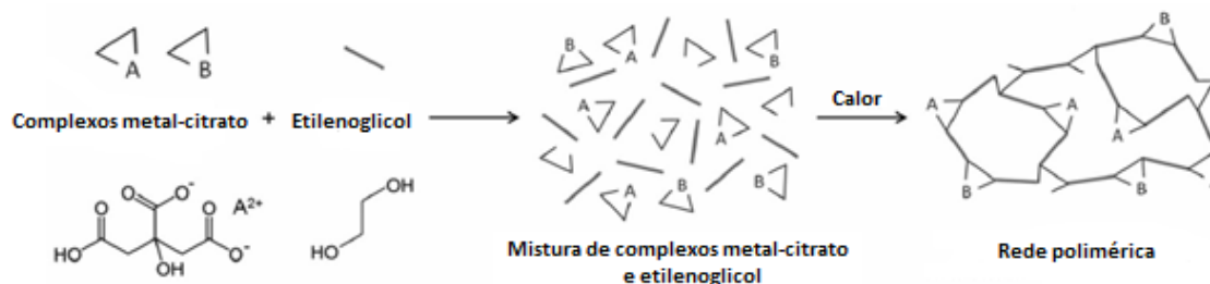
Figura 20 – Esquema da síntese da perovskita pelo método de Pechini, Adaptado de DANKS; HALL; SCHNEPP (2016).
