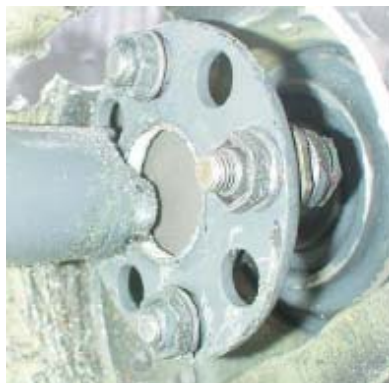
Figura 3.19: Região de rompimento do eixo do rotor, durante o voo, do helicóptero Robinson R22, prefixo ZK-HVN, acidentado em 2005.
