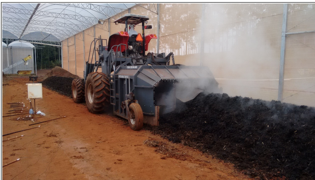
Figura 9. Equipamento para revolvimento de leiras de compostagem
