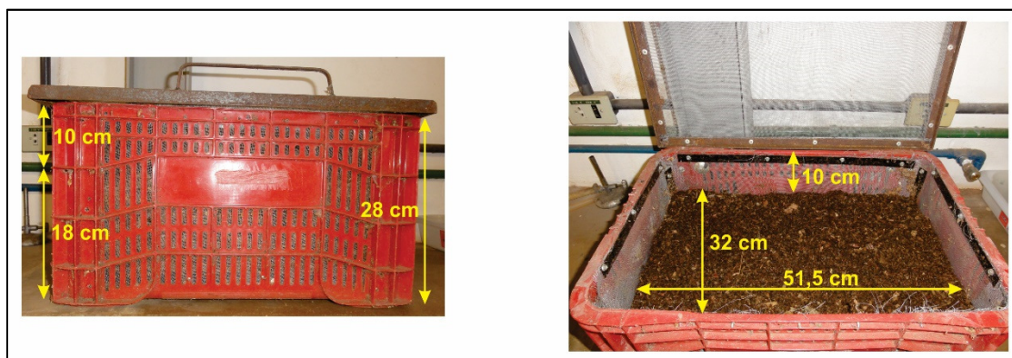
Figura 20. Medidas internas da caixa de PEAD
