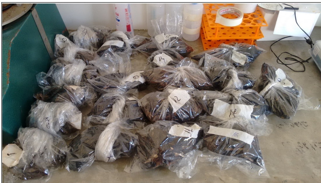
Figura 42. Amostras de composto obtidas nos pontos dos termopares na leira de compostagem
