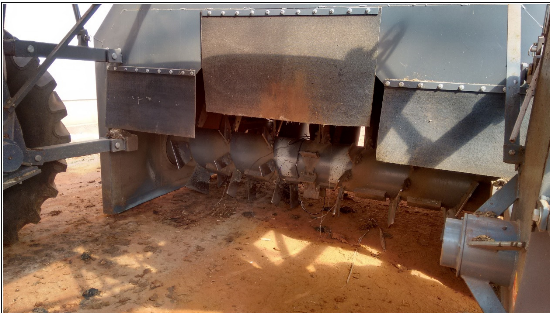
Figura 36. Eixo de revolvimento da compostadeira
