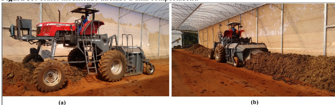
Figura 35. Trator modificado atrelado a uma compostadeira
