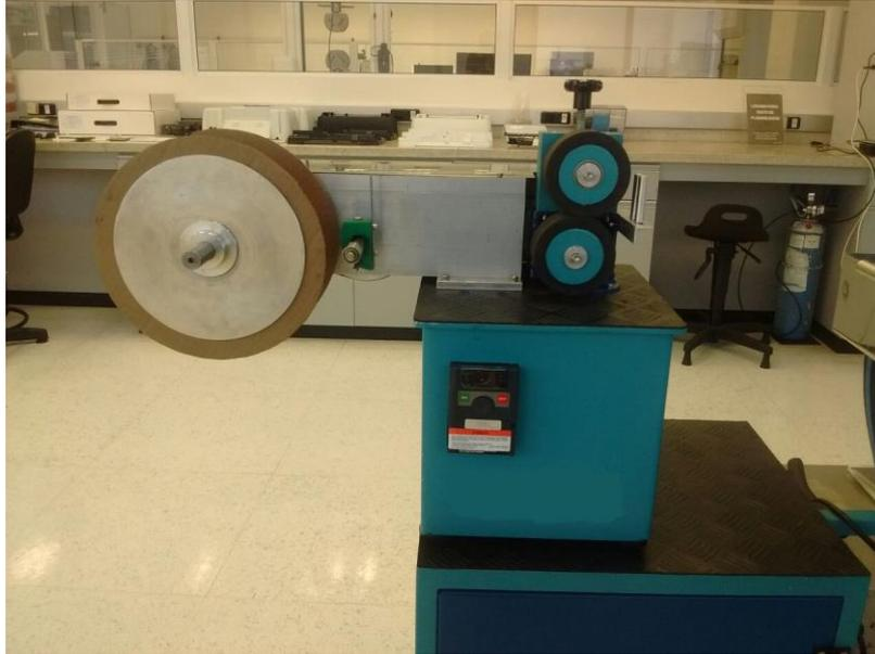
Figura 23 - Equipamento que realiza o bobinamento dos filamentos após a extrusão
