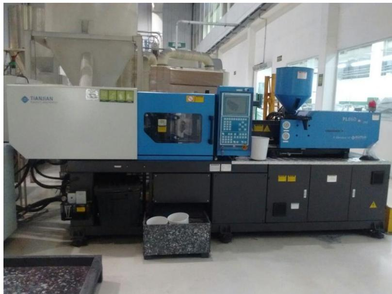
Figura 22 - Equipamento de moldagem por injeção (injetora) utilizado no estudo de caso
