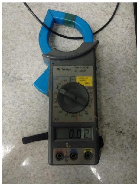
Figura 27 - Amperímetro alicate utilizado para aquisição de dados
