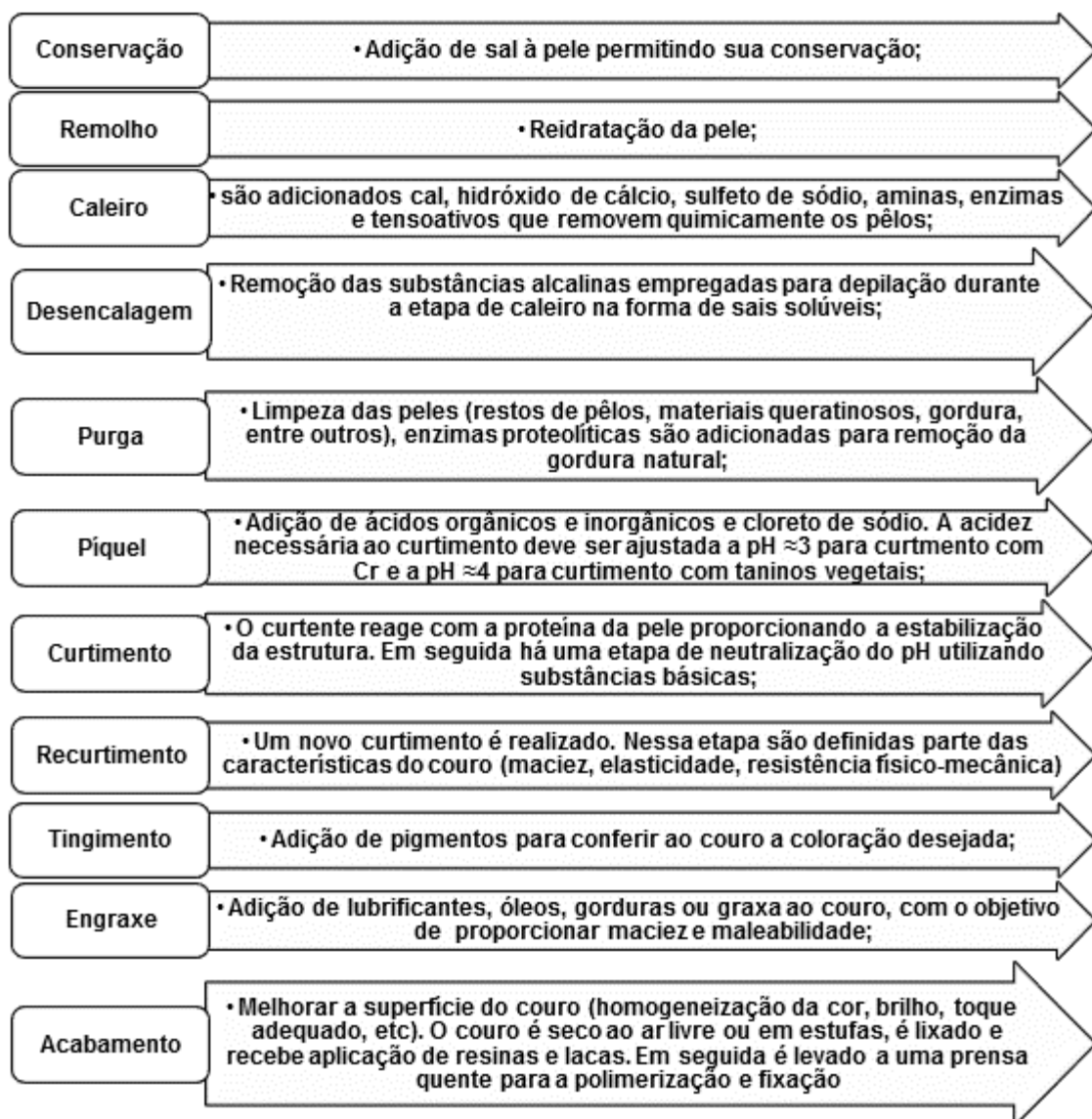
FIGURA 2.1.1 - Principais etapas do processo que transforma pele em couro acabado.
