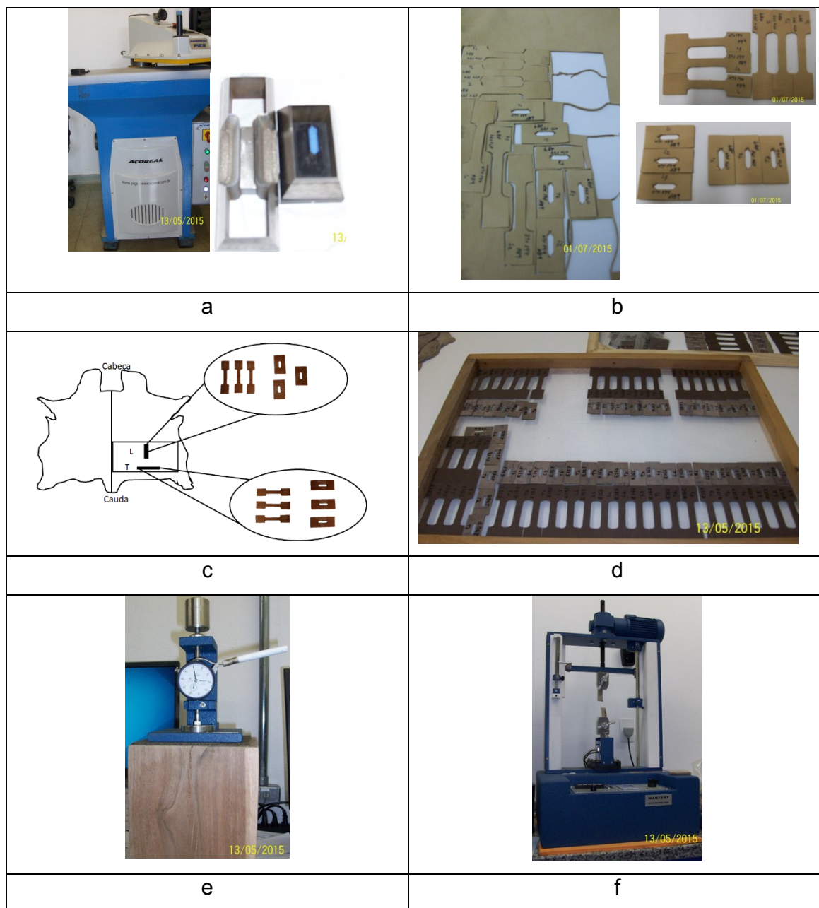
FIGURA 4.1.2.1 - (a) Prensa hidráulica e lâminas para corte dos CP (b) Couro após corte dos CP (c) Região da retirada dos CP nas direções L e T paralelas ao eixo crânio-caudal do animal (d) CP climatizando (e) Espessímetro (f) Dinamômetro.
