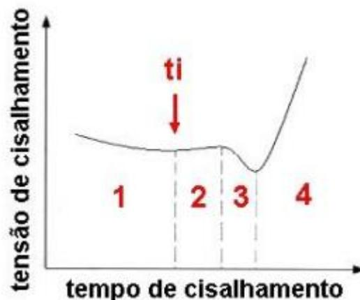
Figura 2.15 – Regiões obtidas nos ensaios reológicos realizados por Farah e Bretas [60].
