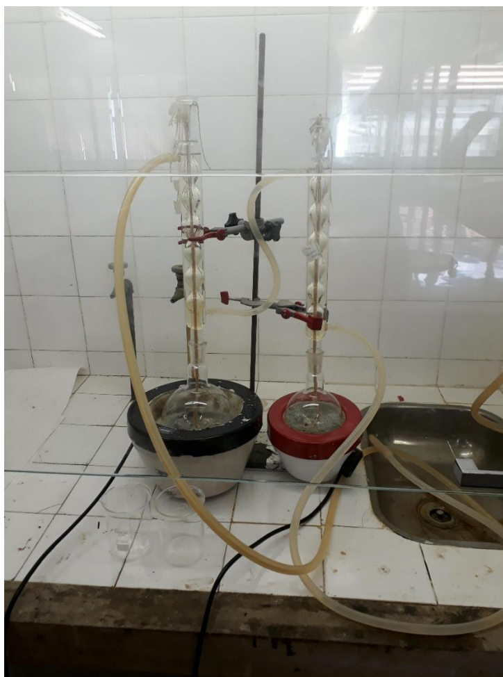
Figura 5.6: Aparato utilizado para extração da matriz e separação das fibras dos compósitos.
