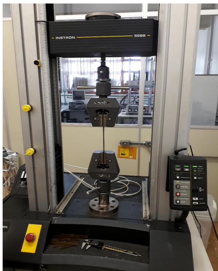
Figura 5.8: Máquina Universal utilizada nos ensaios de tração dos compósitos.
