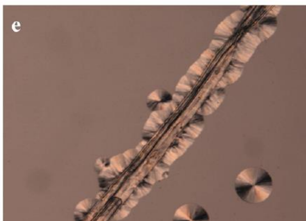
Figura 6.10: Morfologias cristalinas tipicamente encontradas em compósitos de PLA com fibras de sisal [64].
