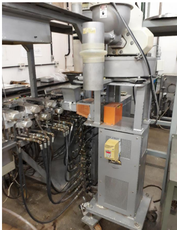
Figura 5.3: Alimentador lateral utilizado para a alimentação das fibras de sisal no 5º barril da extrusora.
