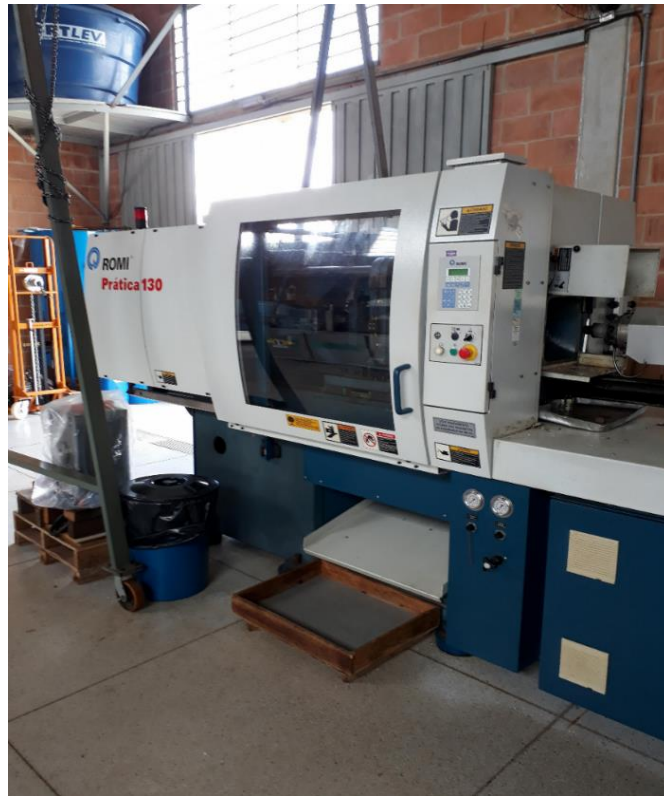
Figura 5.5: Injetora utilizada para a injeção dos corpos de prova para os ensaios mecânicos.
