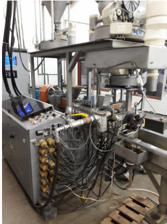
Figura 5.2: Extrusora utilizada para a preparação dos compósitos.
