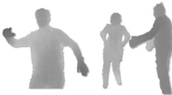
Figura 15. Exemplo de poses em imagens de profundidade geradas por um sensor Kinect. Adaptado de (SHOTTON, FITZGIBBON, et al., 2011).
