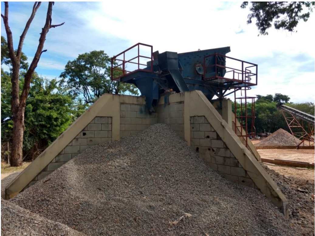
Figura 31 - Peneira vibratória e baias de concreto da usina de reciclagem de RCC de SJRP.
