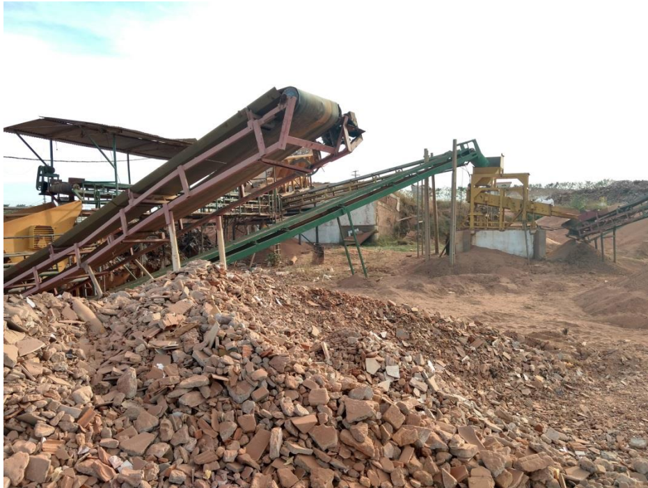
Figura 49 - Esteira transportadora e pilha de bica corrida da usina de reciclagem de RCC de Bady Bassitt.
