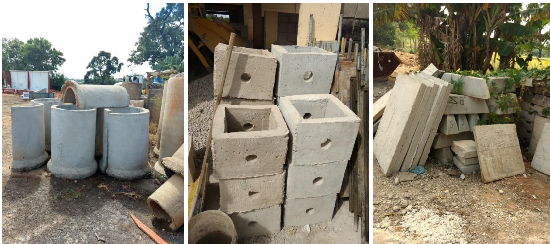
Figuras 19, 20 e 21- Tubos, caixas de passagem, tampas e obstáculos de concreto produzidos na fábrica da usina de reciclagem de RCC de SJRP, respectivamente.
