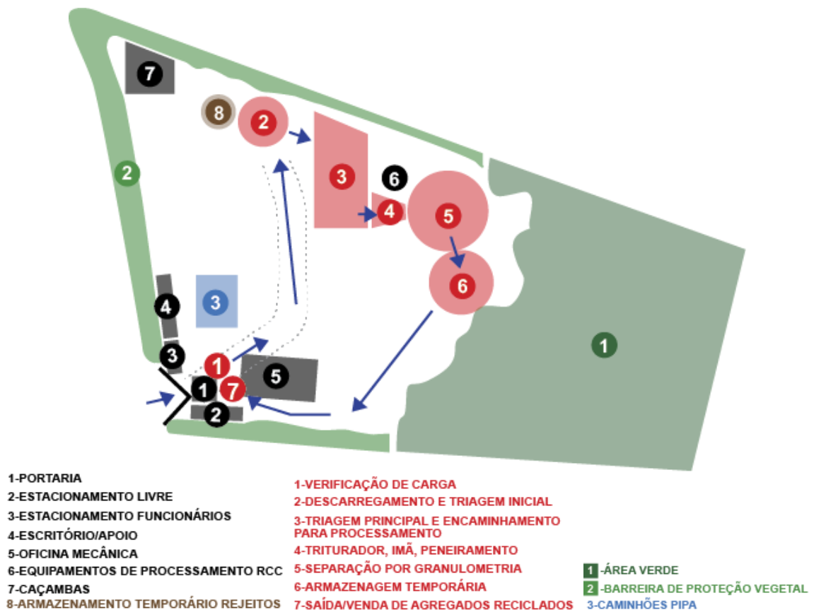
Figura 44 - Planta esquemática da produção da usina de reciclagem de RCC de Bady Bassitt.
