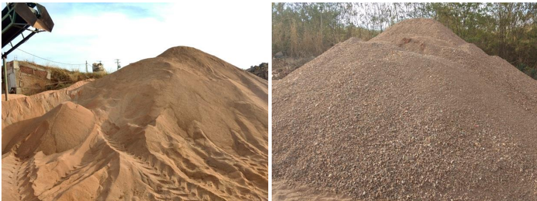
Figuras 42 e 43 - Areia e brita produzidas na usina de reciclagem de RCC de Bady Bassitt, respectivamente.
