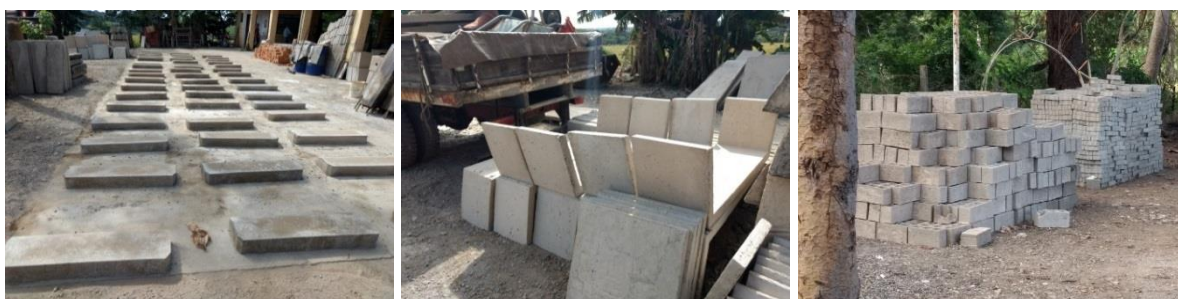
Figuras 22, 23 e 24 - Guias, bancos e blocos de concreto produzidos na fábrica da usina de reciclagem de RCC de SJRP, respectivamente.
