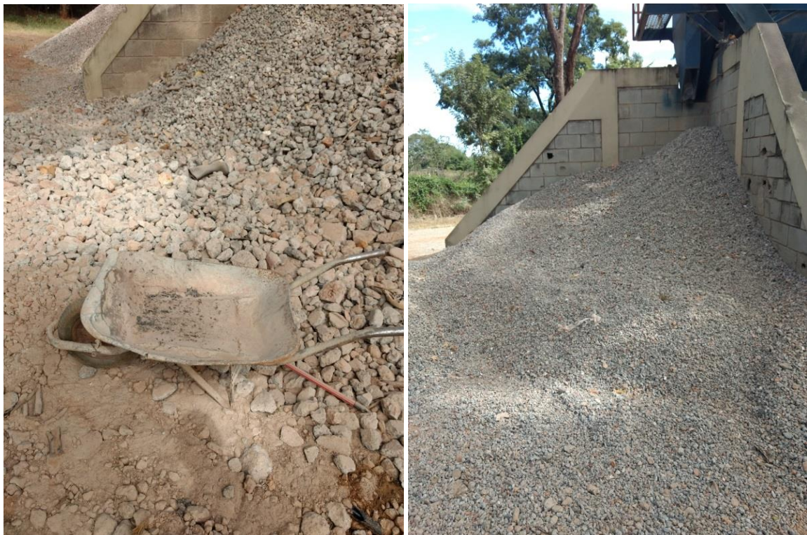
Figuras 17 e 18 - Bica corrida e brita produzidas na fábrica da usina de reciclagem de RCC de SJRP, respectivamente.
