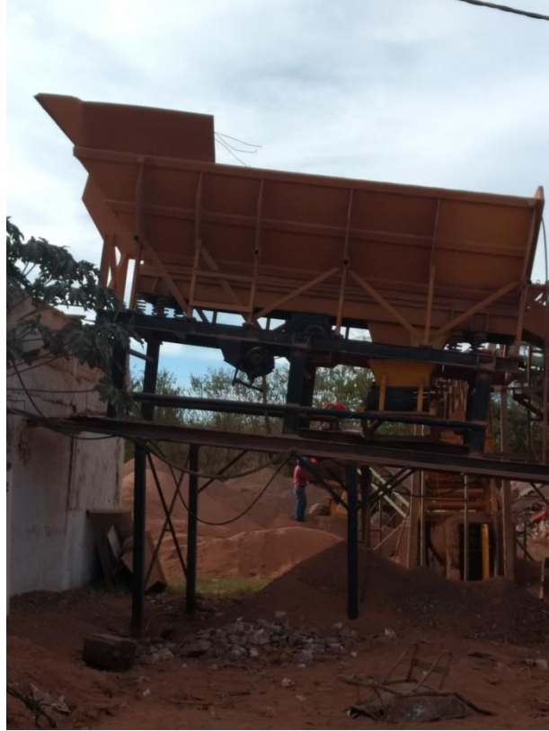
Figura 47 - Equipamento alimentador vibratório da usina de reciclagem de RCC de Bady Bassitt.
