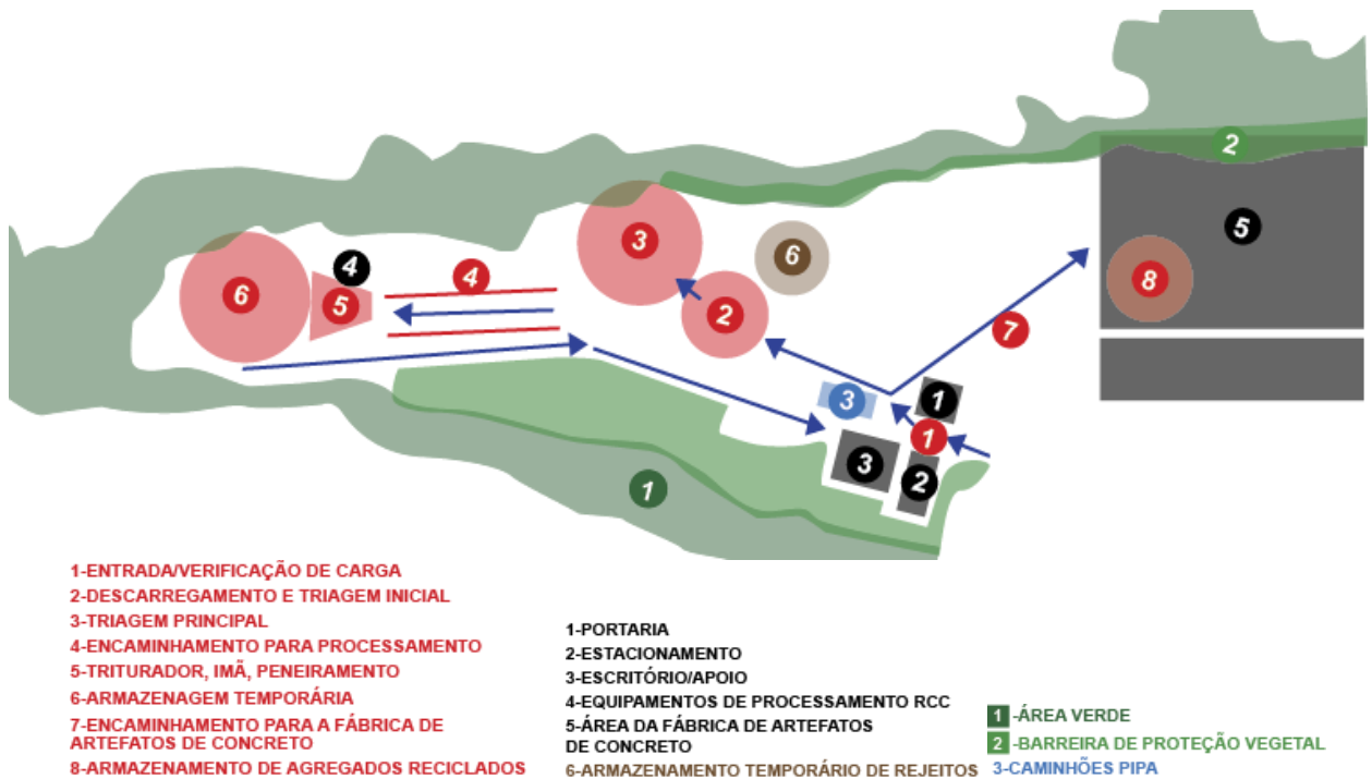
Figura 25 - Fluxograma do processo de produção da usina de reciclagem de RCC de SJRP.
