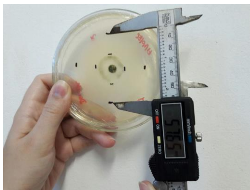
Figura 4. Medição de crescimento micelial com paquímetro digital
