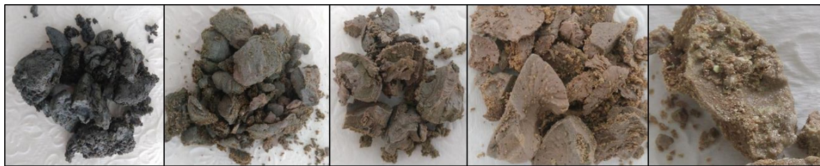
FIGURA 5.3 – Copolímeros com teores de 30, 50, 60, 70 e 90% em massa de S 8 (V30, V50, V60, V70 e V90), respectivamente.
