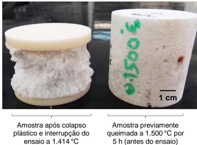
Figura 4.15 Amostra do concreto PC.1 após ensaio de refratariedade sob carga.
