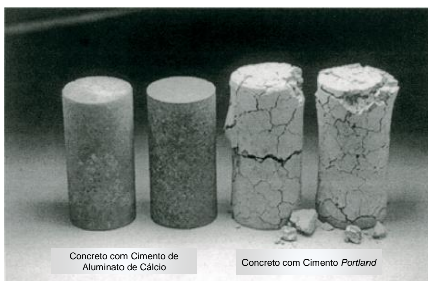
Figura 2.7 Amostras de concretos a base cimento de aluminato de cálcio e Portland depois de 8 ciclos de 6 horas na temperatura de 500 °C, seguido de 24 horas em ambiente úmido. [36]
