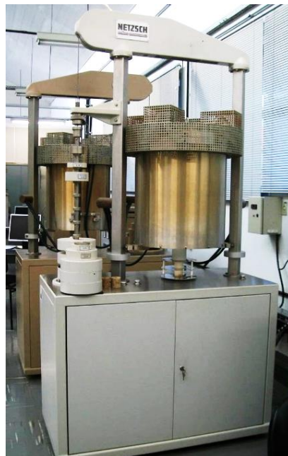
Figura 3.5 Equipamento NETZSCH-421 para o ensaio de refratariedade sob carga.
