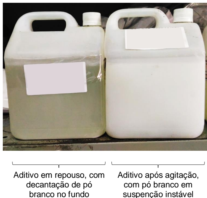
Figura 4.19 Instabilidade do aditivo do concreto PC.3.
