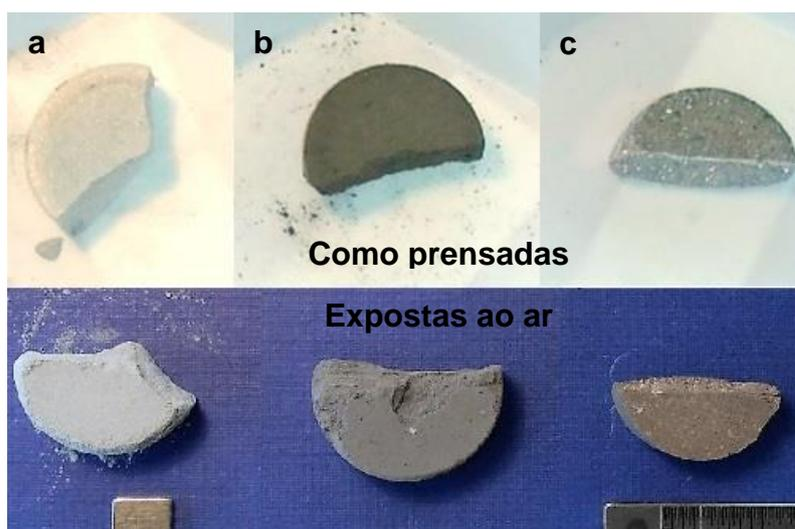
**Figura 5.9** Pastilhas como prensadas e após 1 mês de exposição ao ar. **a)** MgH<sub>2</sub>-Com-Cp **b)** MgH<sub>2</sub>-BM-Cp **c)** Mg+15MgH<sub>2</sub>-Cp
