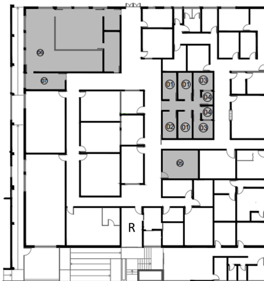
Figura 2. Planta da Clínica e Serviço Escola de Psicologia, em escala de 1:100 m. Legenda: R: recepção; 01: Salas de Atendimento Adulto Individual; 02: Sala de Atendimento Infantil; 03: Salas Espelhadas de Atendimento Adulto Individual; 04: Salas de Observação; 05: Atendimento em grupo e supervisão; 06: Laboratório de Observação do Comportamento; 07: Sala de Espera dos alunos.
