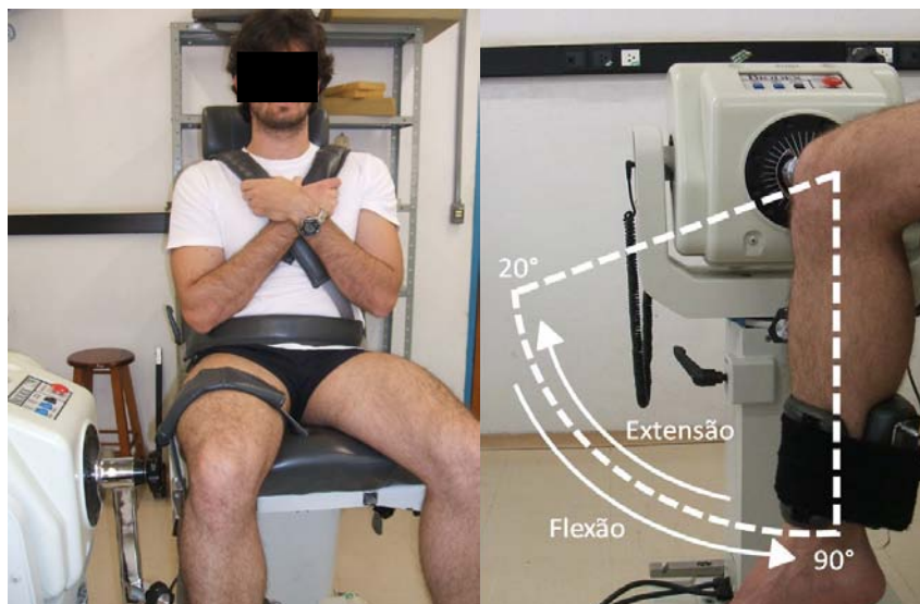
Figura 2. Posicionamento do voluntário no dinamômetro isocinético (lado esquerdo da figura) e amplitude de movimento desenvolvida na avaliação isocinética (lado direito da figura).
