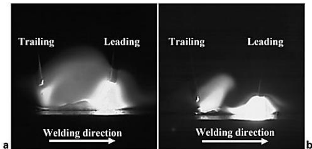
Figura 25 - Comparativo dos comportamentos dos arcos elétricos: a) mistura gasosa de 98% argônio e 2% gás carbônico; b) mistura gasosa de 75% argônio e 25% gás carbônico.
