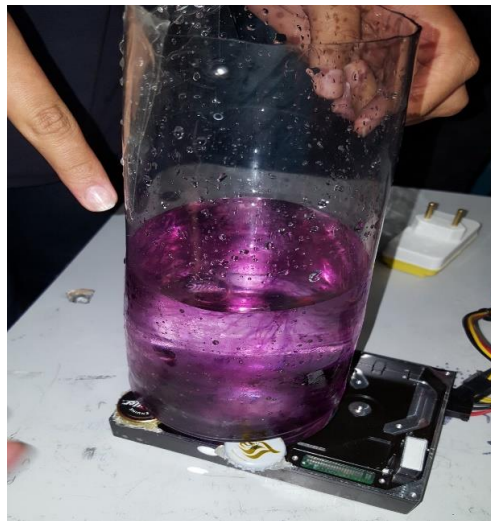
Figura 4.20 — O agitador em funcionamento.
