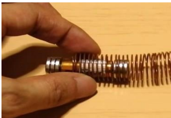
Figura 4.2 — Região onde há corrente produzida pela força eletromotriz da pilha.
