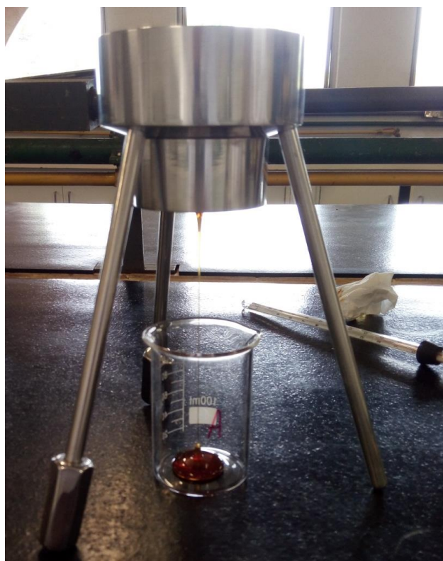
Figura 2. Utilização do copo Ford para análise da viscosidade do melado de cana-de-açúcar.
