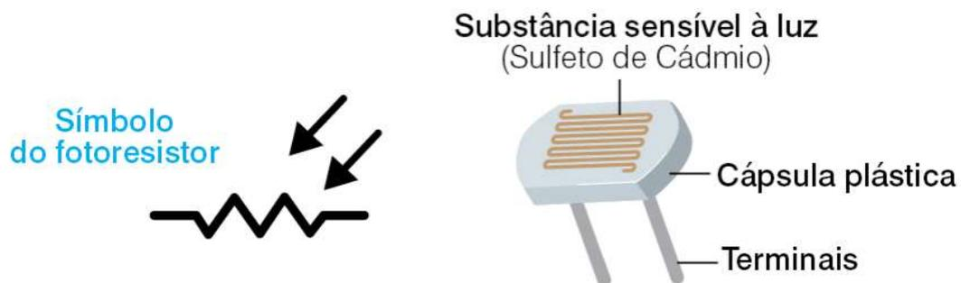
Figura 12. Símbolo e estrutura de um fotoresistor (Fonte: [http://www.dreaminc.com.br/sala\\_de\\_aula/ldr-fotoresistor/](http://www.dreaminc.com.br/sala_de_aula/ldr-fotoresistor/))
