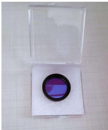
Figura 25. Filtro passa-faixa utilizado na montagem do dispositivo
