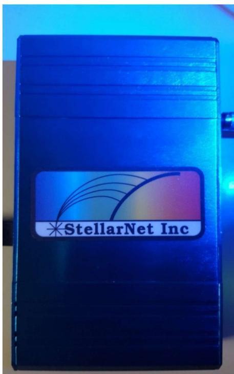
Figura 28. Espectrômetro utilizado para caracterização da fonte de excitação utilizada na construção do sensor.
