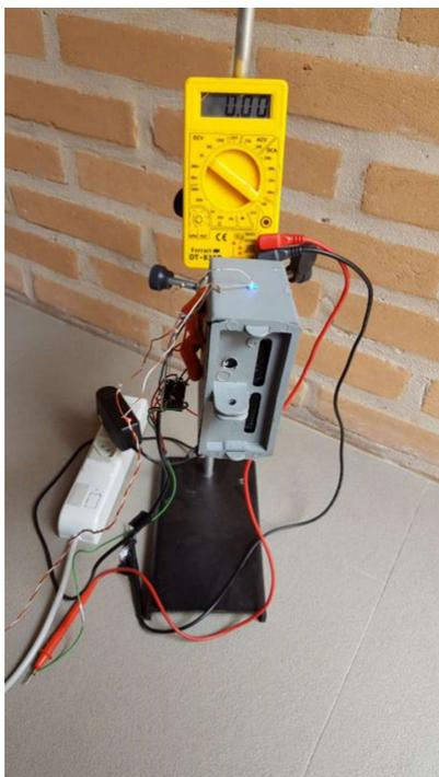
Figura 72. Sensor com lâmina no interior da caixa de detecção, sem clorofila. A tensão indicada no multímetro é 0V, indicando a ausência de clorofila.
