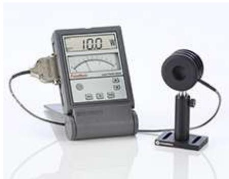
Figura 32. Medidor de potência (low power meter) utilizado na medição da intensidade de emissão das fontes de excitação.
