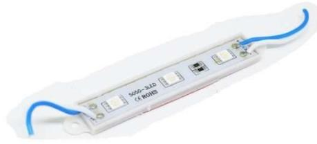
Figura 23. Módulo LED utilizado na montagem do dispositivo
