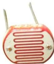
Figura 27. Resistor dependente de luz (LDR) utilizado na montagem do dispositivo.
