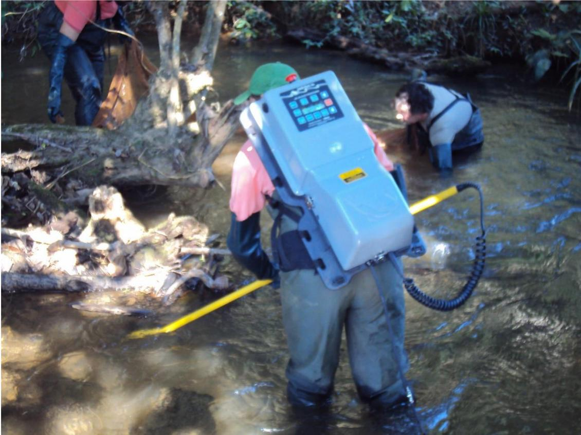
*Figura 12 - Pesca elétrica sendo realizada no ponto 1 de amostragem (método de coleta ativa).*
