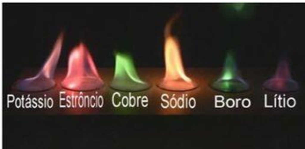
FIGURA 3.7 - Teste de chama e o espectro dos elementos.
