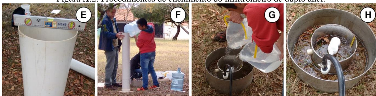
Figura A.2: Procedimentos de enchimento do infiltrômetro de duplo anel.
