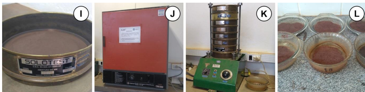
Figura A.6: Procedimentos de peneiramento fino das amostras.
