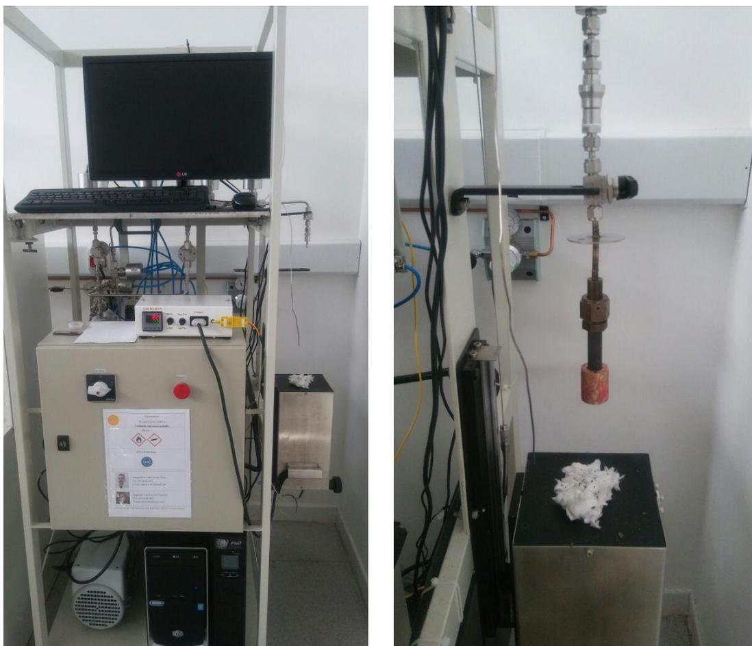
*Figura 4.2 - Equipamento de construção própria utilizado para obtenção das curvas de cinética para as amostras estudadas neste trabalho. a) unidade stand-alone mostrando a vista frontal do equipamento; b) região do porta-amostra, logo acima do forno.*
