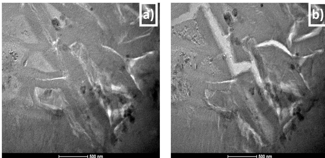
*Figura 5.17 - Imagens de MET convencional em campo claro para a amostra Mg<sub>8</sub>Fe MS após 3 absorções: a) após poucos segundos de exposição e b) após maior tempo de exposição ao feixe, mostrando a provável decomposição da fase hidreto e formação de trincas pela retração volumétrica.*
