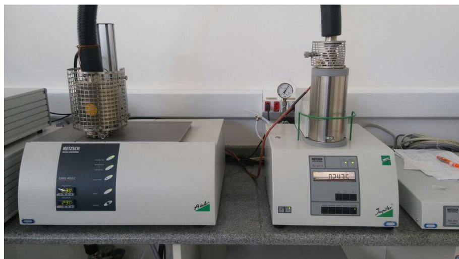
Figura 4.3 - Equipamento Netzsch STA 449 Jupiter utilizado neste trabalho para medidas de DSC com TG e QMS acoplados.
