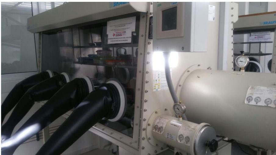
*Figura 4.1 - Glove box utilizada para armazenamento das amostras.*
