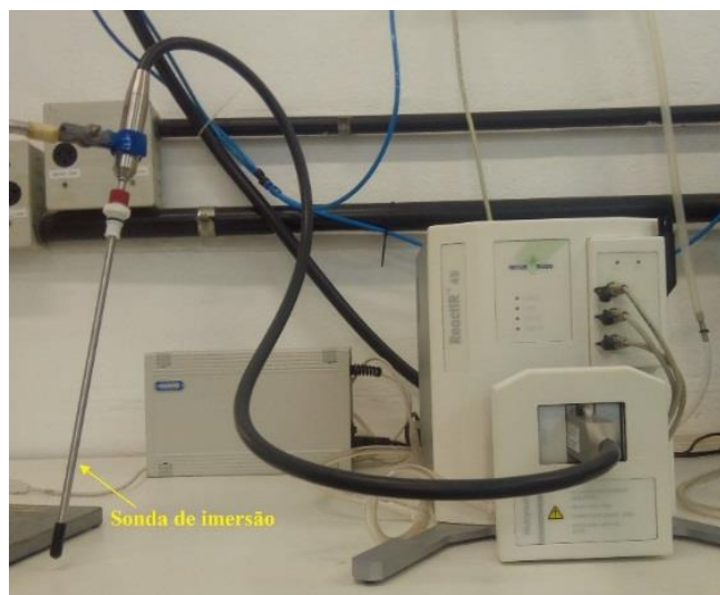
Figura 4.2 - Espectrofotômetro FT-MIR utilizado para obtenção dos dados espectrais.
