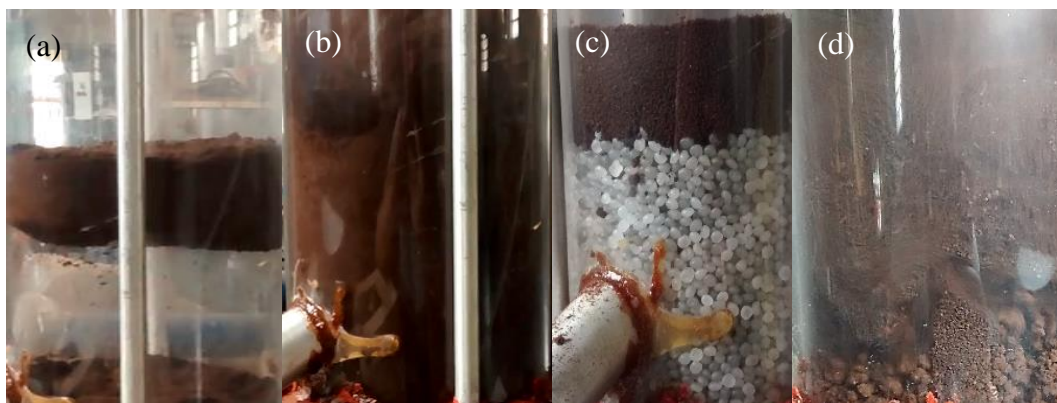
Figura 16 - (a) escoamento pistonado da borra úmida (b) fluidização da borra seca (c) teste borra e polipropileno (d) fluidização da borra úmida na presença da borra seca.
