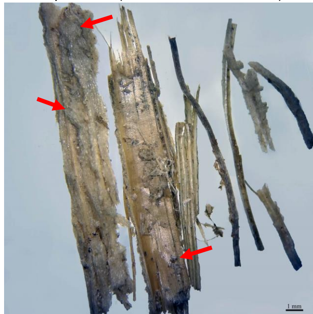
Figura 24 - Imagem do microscópio estereoscópico do bagaço com presença de impurezas (Com aumento de 10x)
