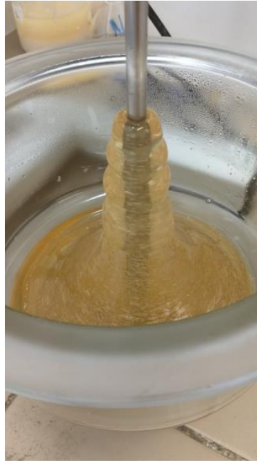
Figura 19 - Síntese do HEDTA (Ponto gel)
