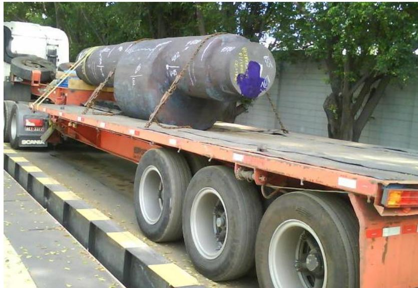
Figura 2.11 - Peça forjada pela Villares Metals S.A. em prensa de matriz aberta de 50 MN a partir de um lingote de 45 toneladas.
