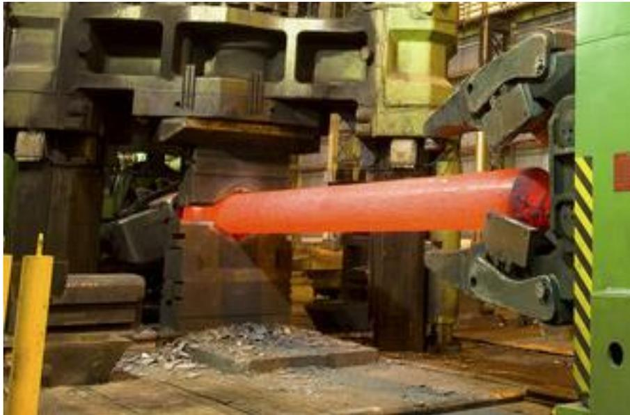
Figura 2.13 – Forjamento em matriz aberta com ferramental em forma de “V” pela empresa Villares Metals S.A. em uma prensa hidráulica de 50 MN [33].
