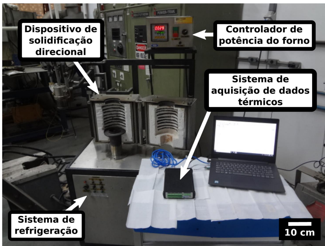
Figura 3.8. – Fotografia do equipamento de solidificação direcional utilizado no presente estudo pertencente ao laboratório Microestrutura e Propriedades em Processos de Solidificação (M2PS) - UFSCar.
