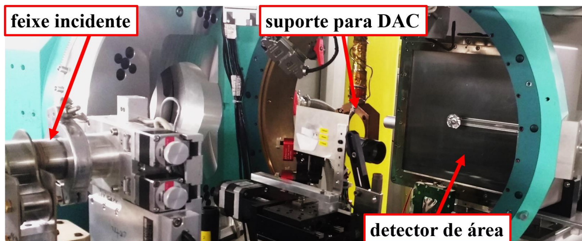
Figura 3.4: Foto da linha de luz XDS do Laboratório Nacional de Luz Síncrotron (LNLS), destacando o caminho do feixe incidente, o suporte para a DAC e o detector de área.
